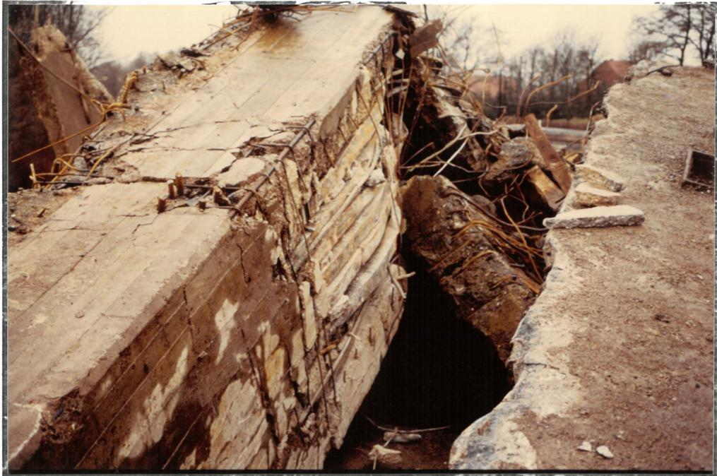
Abb. 35 Hohlkastenbruchstücke aus denen Spanngliedabschnitte entnommen werden konnten
