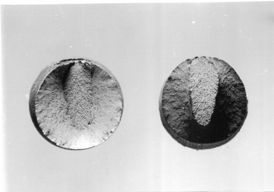
Abb. 49: Vergrößerung 3:1 Duktiler Bruch Stahl D 2, Versuch 86
