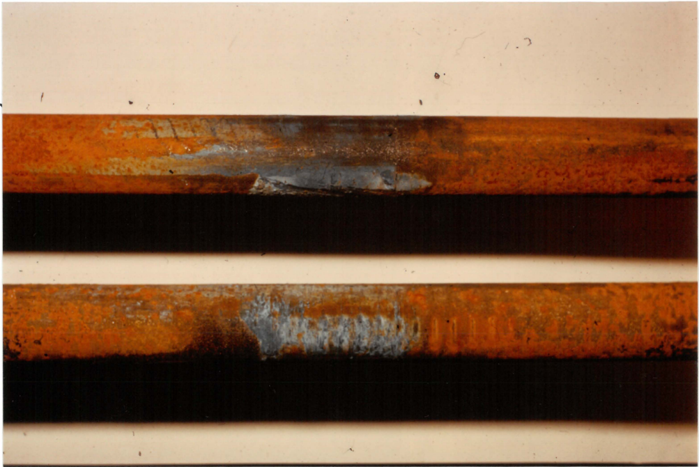
Abb. 10: Vorkorrosion in \text{NO}_3^- -haltiger Umgebung im Bereich der Farbmarkierungen, Stahl B
