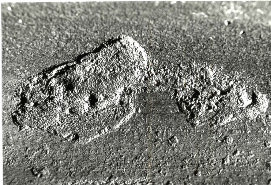
Abb. 29: Vergrößerung 5:1 Korrosionsnarben an Stab Nr. 15, Stahl A Standzeit >1000 h
