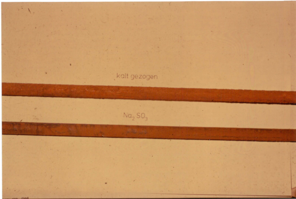
Abb. 6: Vorkorrosion in \text{SO}_3^{--} -haltiger Umgebung (300 mg/l) Stahl E
