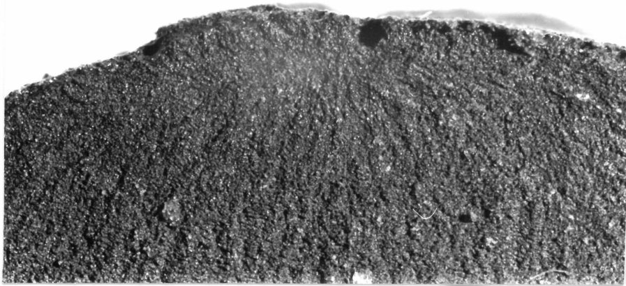
Abb. 20: Vergrößerung 30:1 Lochfraßnarbe am Bruchausgang, Versuch 75
