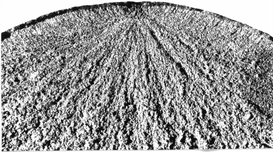
Abb. 32: Vergrößerung 12:1 Bruchausgang Versuch 12, Stahl B
