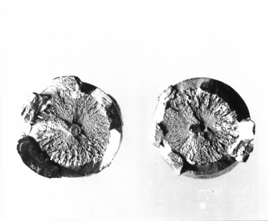
Abb. 38: Vergrößerung 3:1 Spröder Bruch Stahl E, Versuch 69
