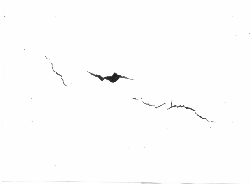
Abb. 44: Vergrößerung 190:1 Querschliff mit Innenriß, Stahl E, Versuch 69
