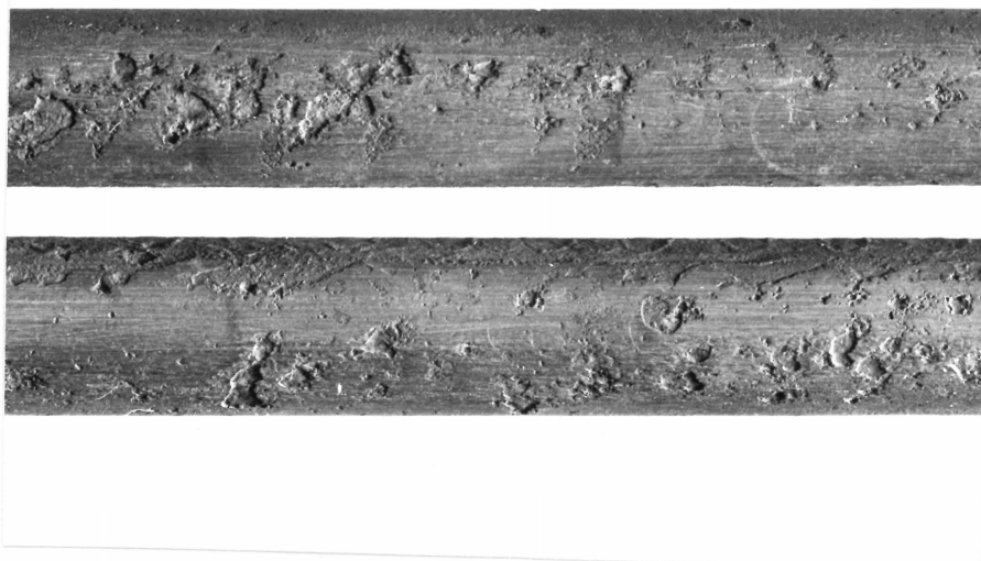
Abb. 45: Vergrößerung 2:1 Narbenkorrosion in der Umgebung des Bruches Stahl E, Versuch 66
