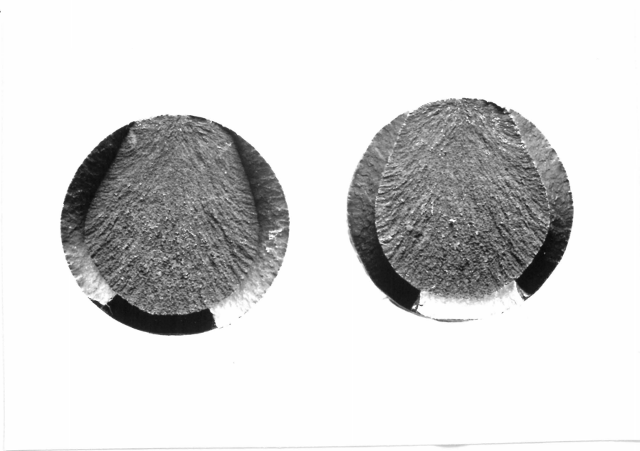
Abb. 48: Vergrößerung 3:1 Sprödbbruch Stahl D 2, Versuch 81
