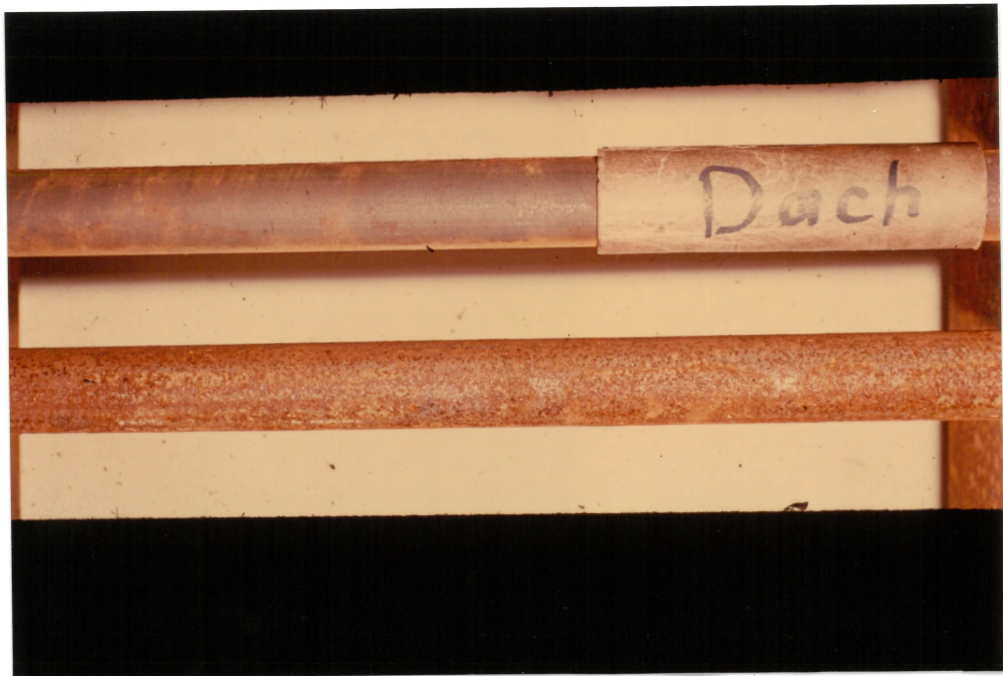
Abb. 11: Korrosionserscheinungen nach 12-wöchiger Auslagerung im Hüllrohr auf dem Dach der BAM, Stahl A unten, Stahl B oben
