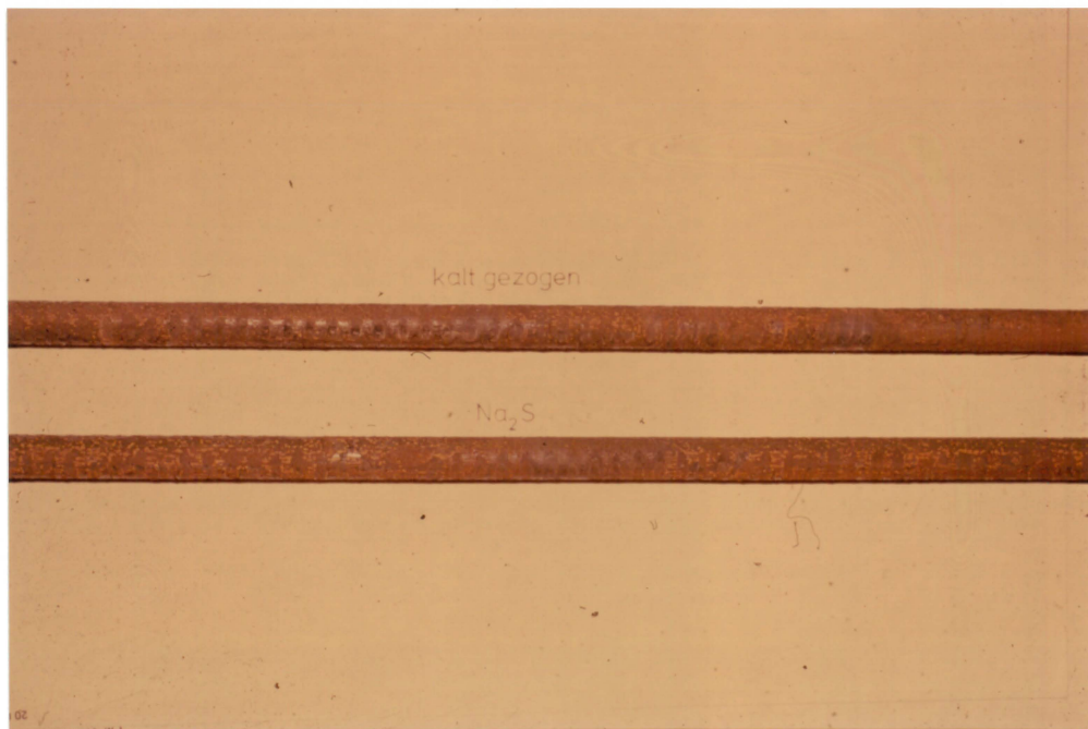
Abb. 7: Vorkorrosion in \text{S}^{--} -haltiger Umgebung (300 mg/l), Stahl E
