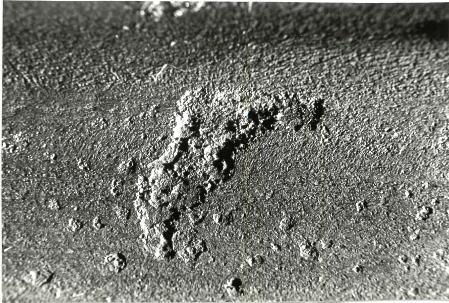
Abb. 28: Vergrößerung 5:1 Korrosionsnarben an Stab Nr. 15, Stahl A Standzeit >1000 h
