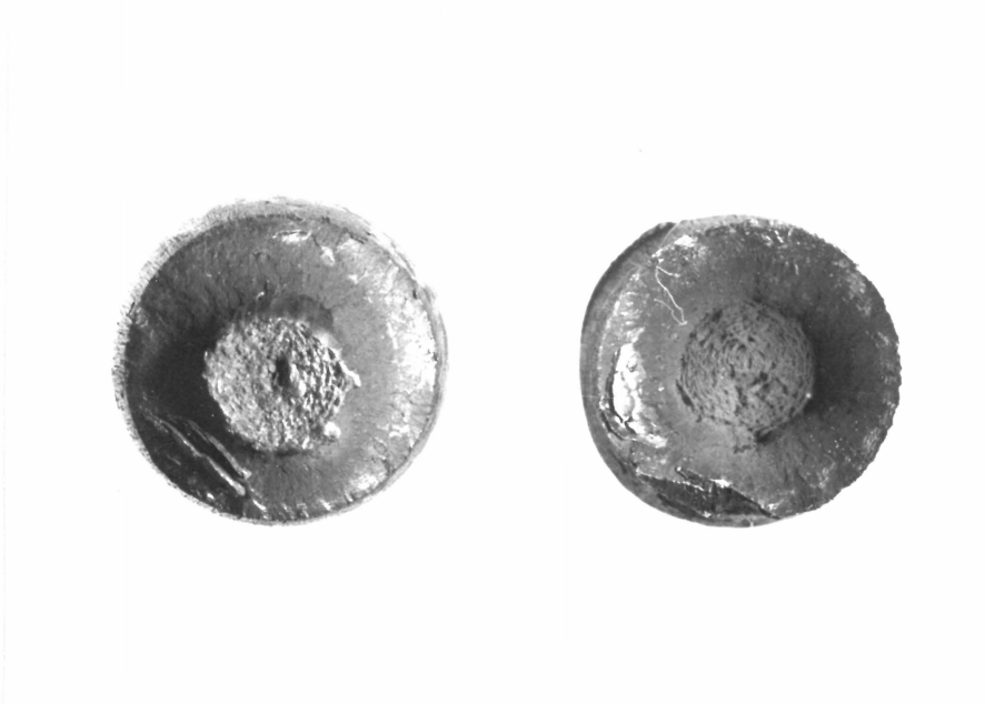
Abb. 37: Vergrößerung 3:1 Duktiler Bruch Stahl E, Versuch 63
