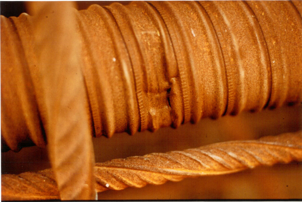
Abb. 35 Knick und Loch am Hüllrohr
