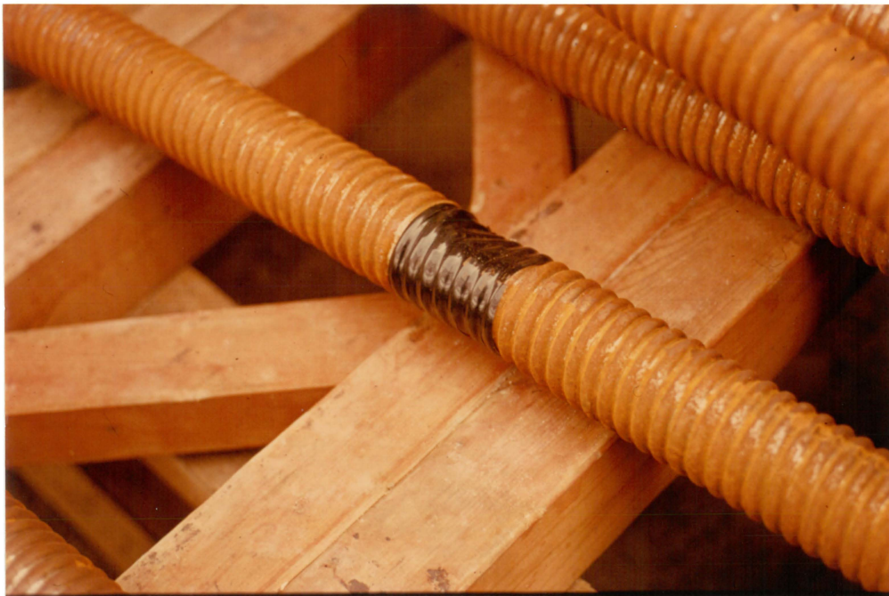
Abb. 38 Knick am Hüllrohr
