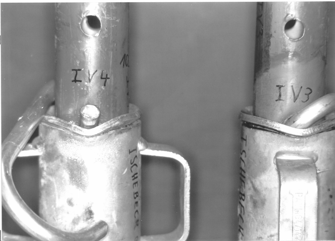
Bild 42 : Details der Probekörper nach dem Versagen ISCHEBECK Gr. 4
