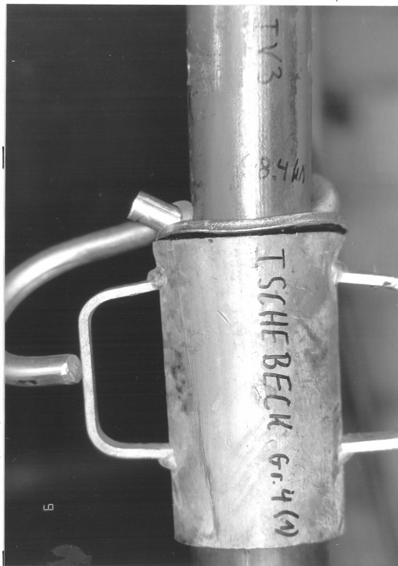
Bild 26 : Laststufe 98.4 kN Höchstlast ISCHEBECK Gr. 4 (1)
