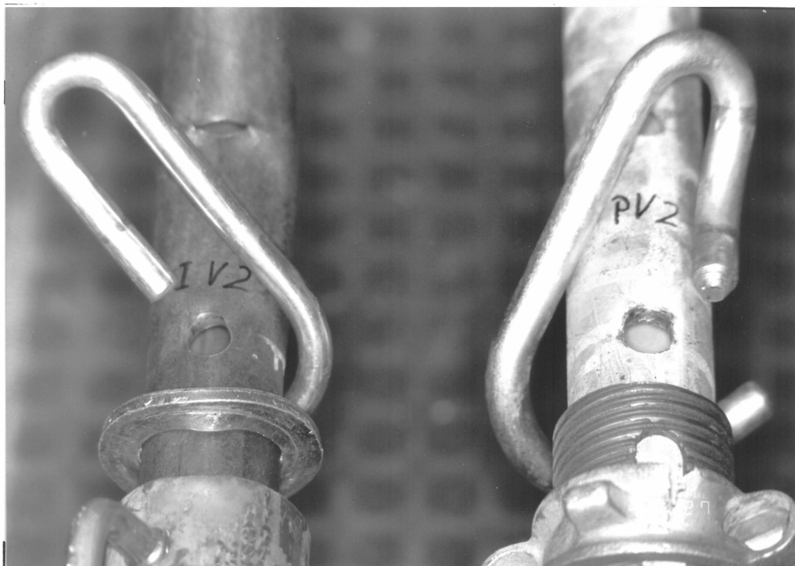
Bild 40 : Probekörper nach dem Versagen (ISCHEBECK Gr. 2 , PERI N )
