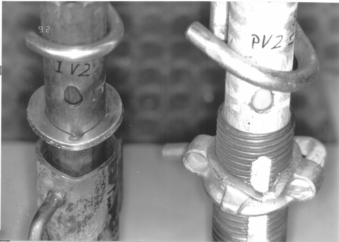
Bild 39 : Probekörper nach dem Versagen (ISCHEBECK Gr. 2 , PERI N )
