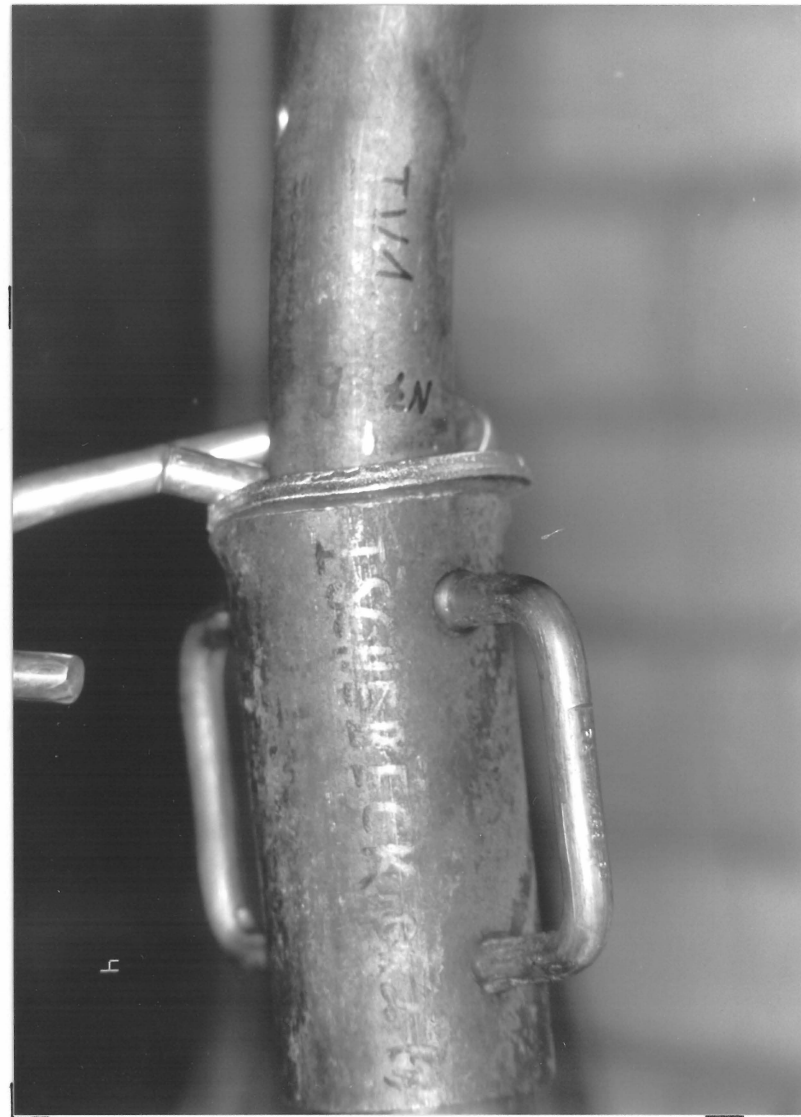
Bild 21 : Laststufe 96 kN = P_{max} . Höchstlast ISCHEBECK Gr. 2 (1)
