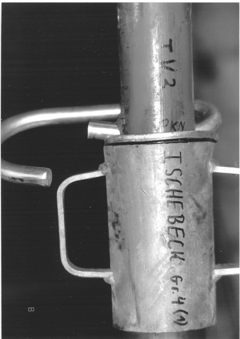
Bild 25 : Laststufe 90 kN ISCHEBECK Gr. 4 (1)
