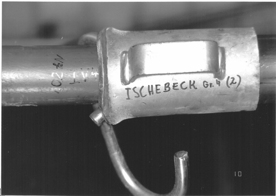
Bild 27: Laststufe 102 kN Höchstlast ISCHEBECK Gr. 4 (2)
