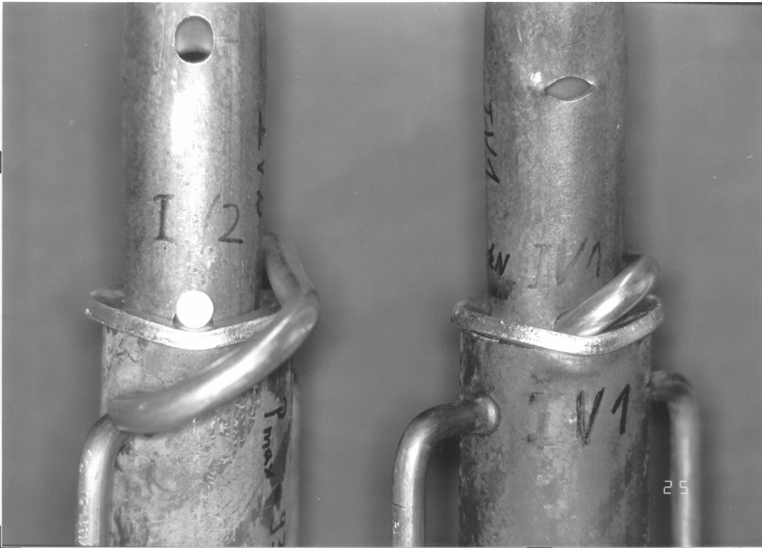
Bild 41 : Details der Probekörper nach dem Versagen ISCHEBECK Gr. 2
