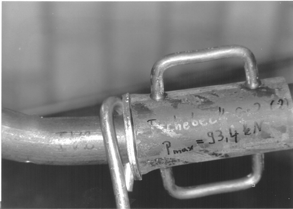
Bild 22 : Laststufe 93.4 kN Höchstlast ISCHEBECK Gr. 2
