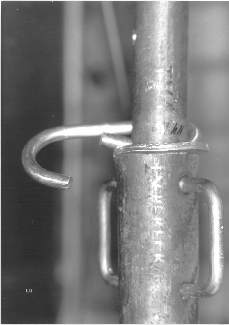
Bild 20 : Laststufe 89 kN ISCHEBECK Gr. 2 (1)
