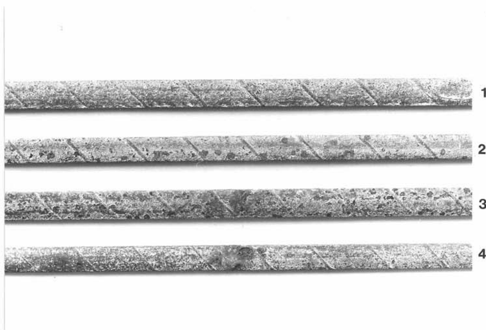
Bild 13. Spannstahloberflächen im Originalzustand
