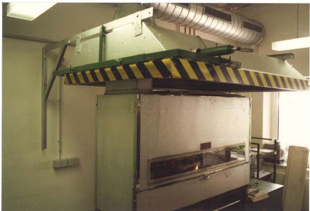
Abb. 1: An der Abzugshaube befestigte Lichtmeßstrecke
