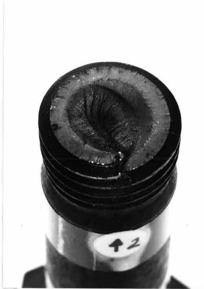
Bild 4.36: Kreisringförmige (k) Dauerschwinganrißfläche einer hochfesten Schraube M 20 unter überwiegender Axiallast. Schraube a des Versuches Nr. T 20 (Versuchsserie 7)
