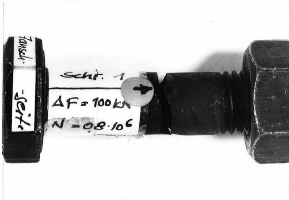
Bild 4.30: Dauerschwingbruch im Schraubenschaft einer hochfesten Schraube M 16. Schraube a des Versuches Nr. T 22 (Versuchsreihe 8). Anrißstelle (Pfeil) zugfanschseitig
