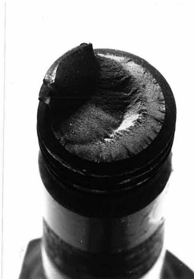
Bild 4.37: Sichelförmige (S) Dauerschwinganrißfläche (rechter Bildrand) einer hochfesten Schraube M 20. Bruchursache Überwiegend Axialbeanspruchung. Schraube a des Versuches Nr. 50 (Versuchsreihe 2). Anrißstelle zugblechseitig
