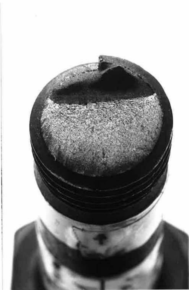
Bild 4.38: Geradlinig (G) angrenzende Dauerschwinganrißfläche und Restbruchfläche einer hochfesten Schraube M 20 unter Überwiegender Biegung. Schraube a des Versuches Nr. 31 (Versuchsreihe 1). Anrißstelle (Pfeil Bildunterkante) zugblechseitig
