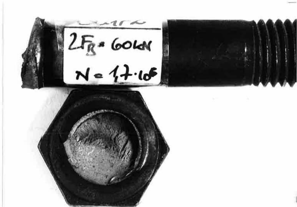
Bild 4.29: Dauerschwingbruch am Schraubenkopf einer hochfesten Schraube M 16, Schraube a des Versuches Nr. V 4 (Versuchsreihe 0). Anrißstelle zugblechseitig, in der Dauerschwingbruchfläche des Schraubenkopfes am unteren Bildrand erkennbar
