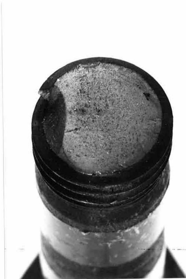
Bild 4.39: Große Dauerschwinganrißfläche A_D > \frac{2}{3}A_3 als Hinweis auf geringe Vorspannkraft zum Zeitpunkt des Restbruches (linke Bildhälfte) an einer hochfesten Schraube M 20. Schraube b des Versuches Nr 43 (Versuchsreihe 2). Anrißstelle (rechte Bildhälfte) zugblechseitig
