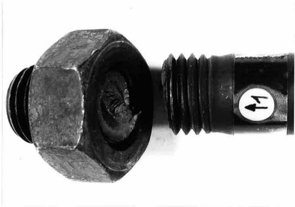
Bild 4.32: Dauerschwingbruch im ersten tragenden Gewindegang einer hochfesten Schraube M 20. Schraube a des Versuches Nr. T 20 (Versuchsreihe 7). Anrißstelle (Pfeil) zugflanschseitig
