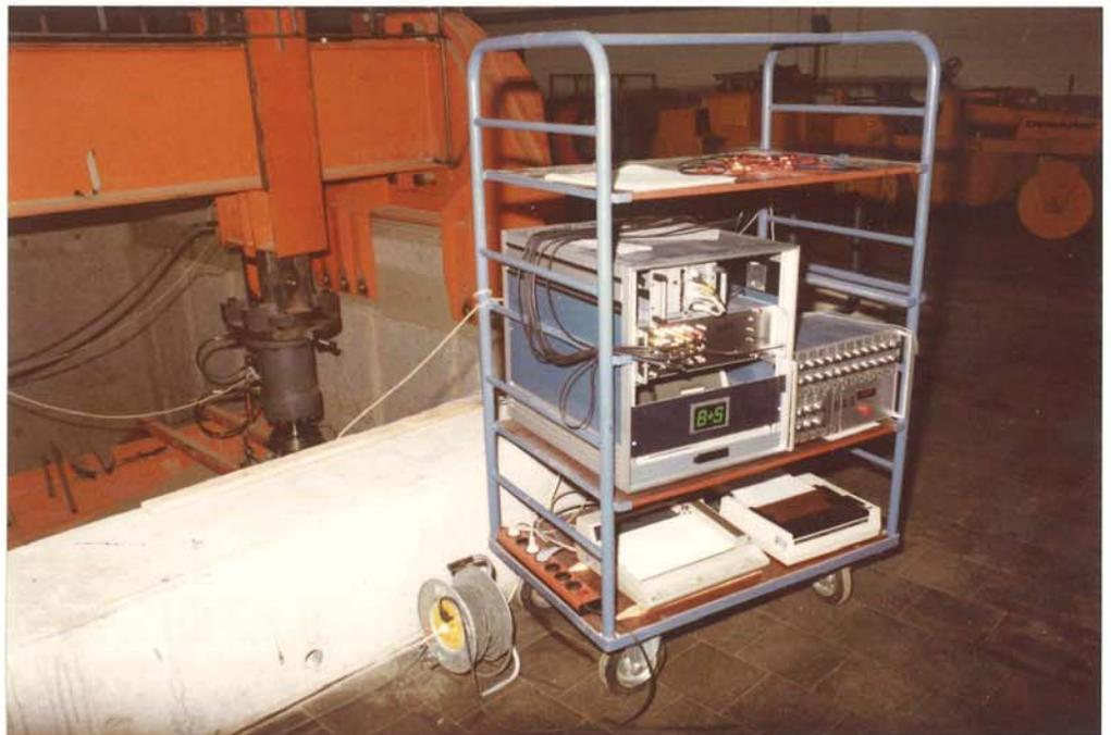
Bild 10: Meßwerterfassung, Steuer-, Regel- und Auswerteeinheiten bei den statischen Versuchen
