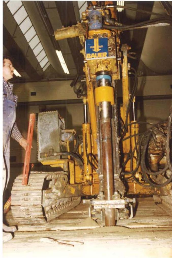
Bild 4: Doppeldrehbohrkopf
