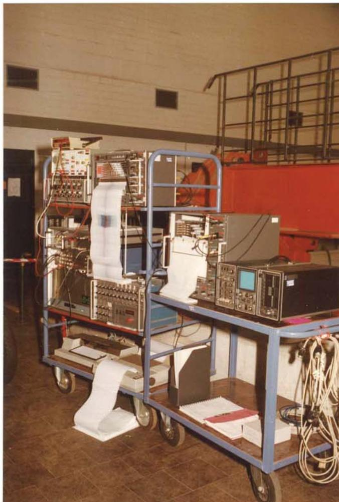
Bild 12: Meßwertaufzeichnung, Steuer-, Regel- und Auswerteeinheiten bei den zyklischen Versuchen
