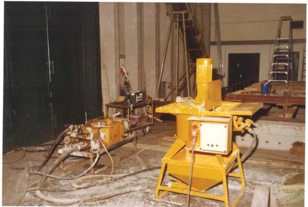
Bild 7: Verpreßeinrichtung mit Mischer, Pumpe und Druckschreiber
