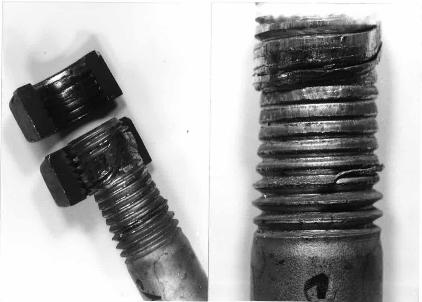
Bild 3: Abgeschertes Bolzengewinde bei N = 15000 Versuch Nr. 56
