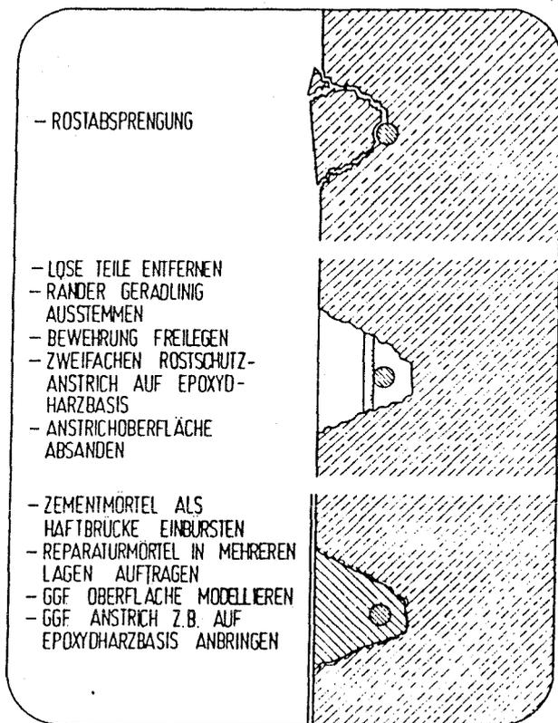
Abb. 3.14: Ausbesserung von Schäden durch Rostabsprengung
