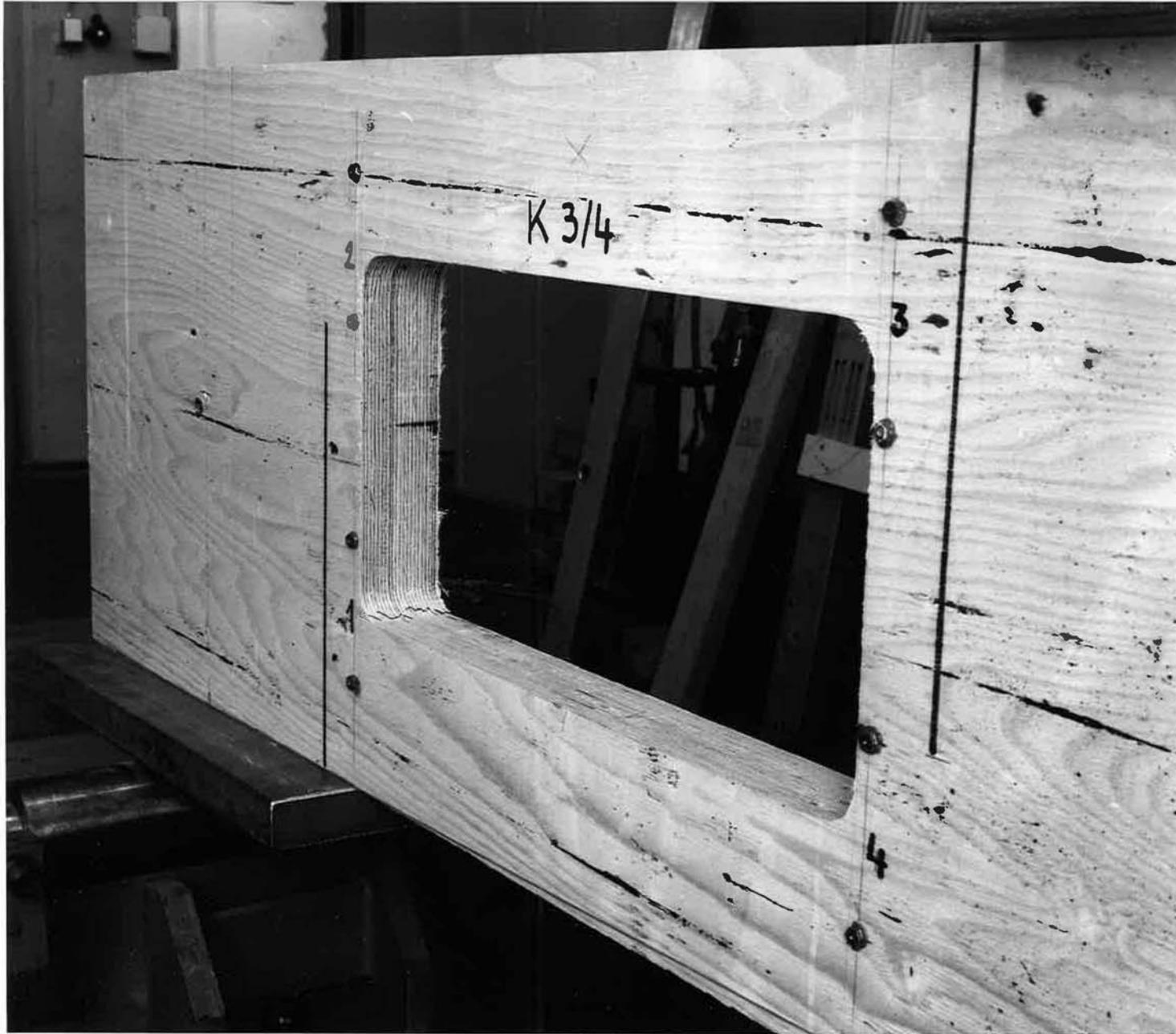
Abb.35 Träger K 3/4 mit rechtwinklig eingeleimten Rippenstählen nach Erreichen der Last  $F_{\text{ges}} = 75 \text{ kN}$
