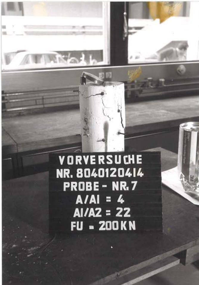
Bilder 3 bis 5: Proben Nr. 7 und 8 mit Teilflächenverhältnissen A/A1 = 4 und A1/A2 = 22 (biegeweich) bzw. A1/A2 = 1 (biegesteif) nach dem Bruch. Deutlich ist auf Bild Nr. 5 die plastische Verformung der Lagerplatte des Versuchs Nr. 7 zu erkennen.
