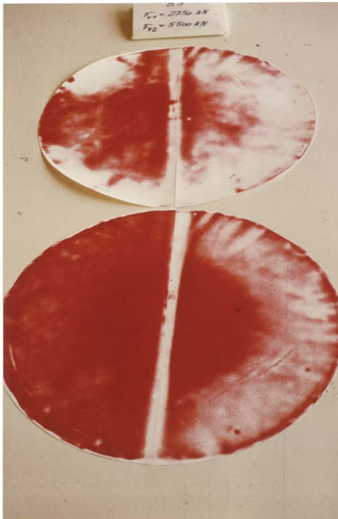
Bild 13: Sohlpressungsabdruck des Versuchs B 9 bei einfacher und doppelter Gebrauchslast
