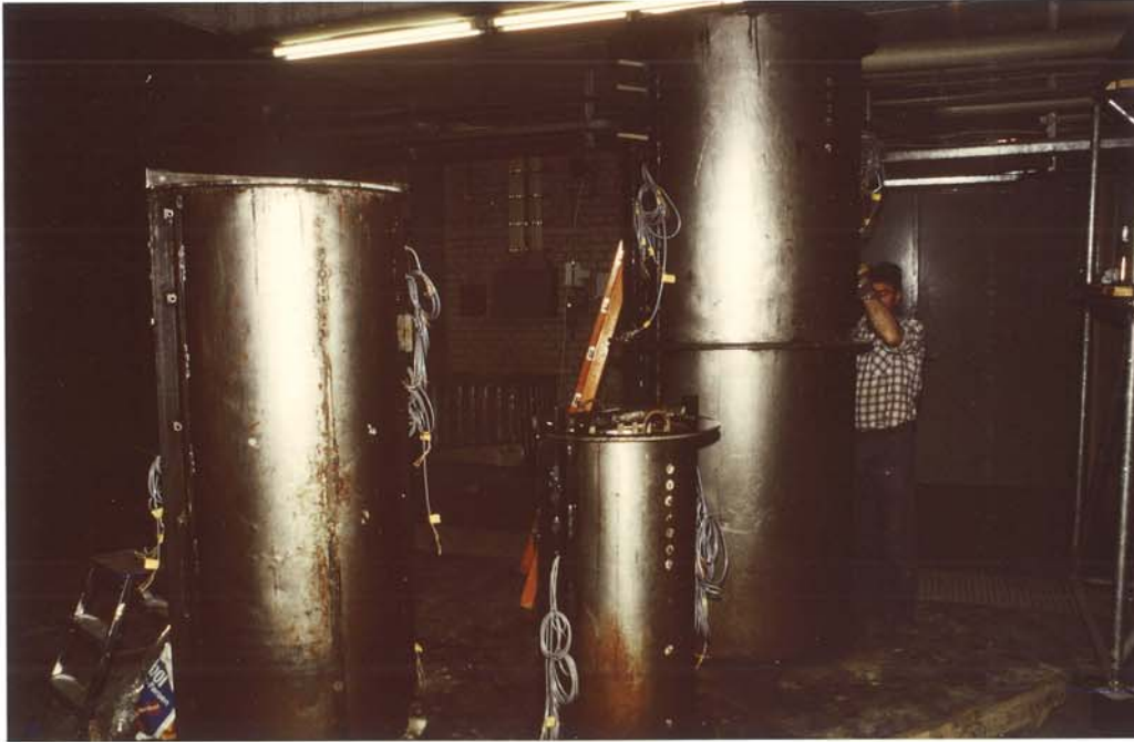
Bild 8 : Probekörper für eine A-Versuchsreihe vor dem Betonieren
