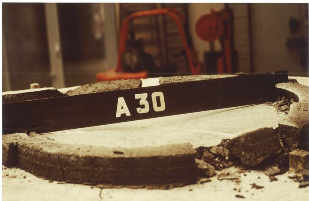
Bilder 23 und 24 : Einstanzen der Lagerplatte bei steifer und bleibende Setzungsmulde bei weicher Lasteintragung in einen Stahlbetonzylinder \varnothing 980 mm nach Versuchsende
