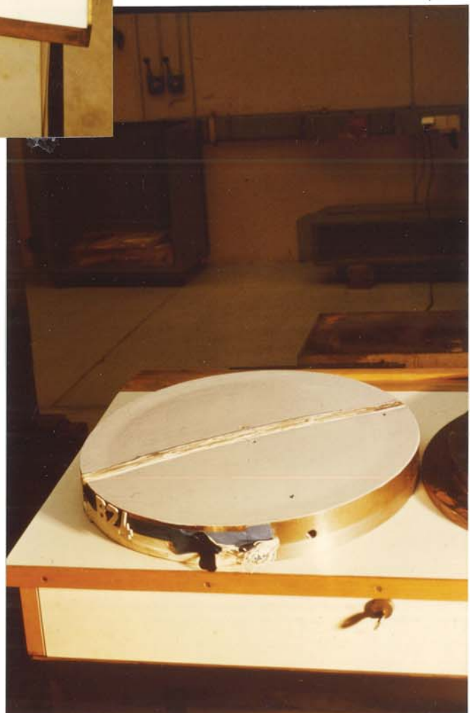
Bild 29: Umgedrehter Topf des Versuchslagers B 24 nach Versuchsende, bei dem deutlich die Wirkung des Krepelmoments in Verbindung mit dem dünnen Topfboden zu erkennen ist.
