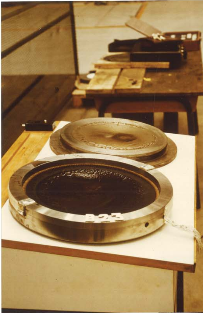
Bild 28: Geöffnetes Topflager des Versuchs B 23 nach Versuchsende; deutlich ist die Konzentration des Schmierfetts im Lagerzentrum als Folge der plastischen Anpassung des Topfbodens an die Setzungsmulde des Betonzylinders zu erkennen
