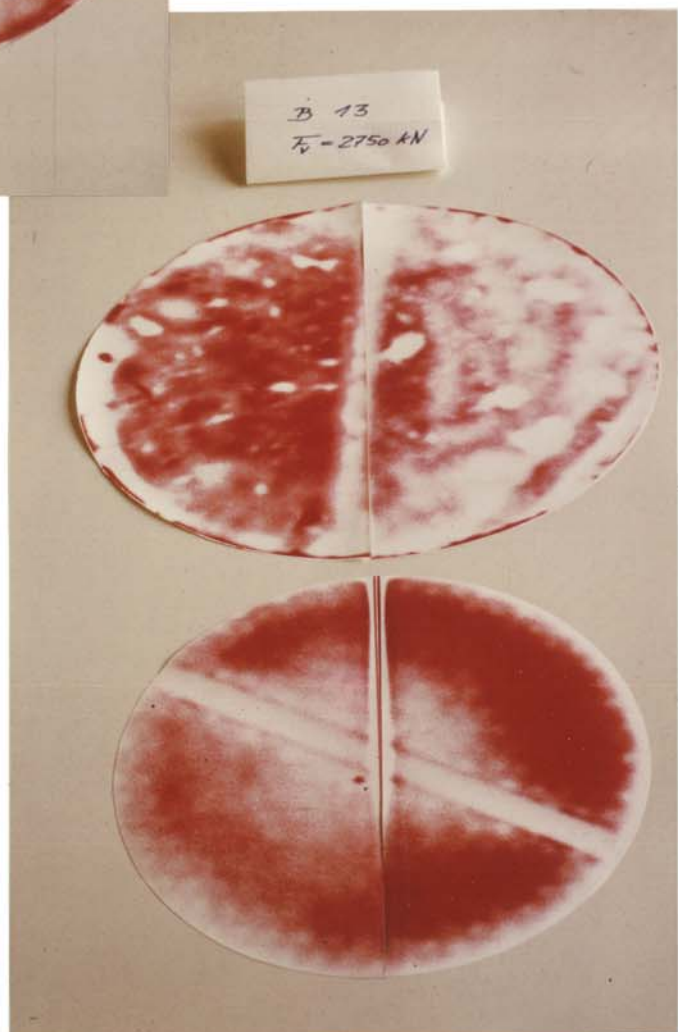
Bild 14: Sohl- und PTFE- Pressungsabdruck des Versuchs B 13 unter rechnerischer Gebrauchslast
