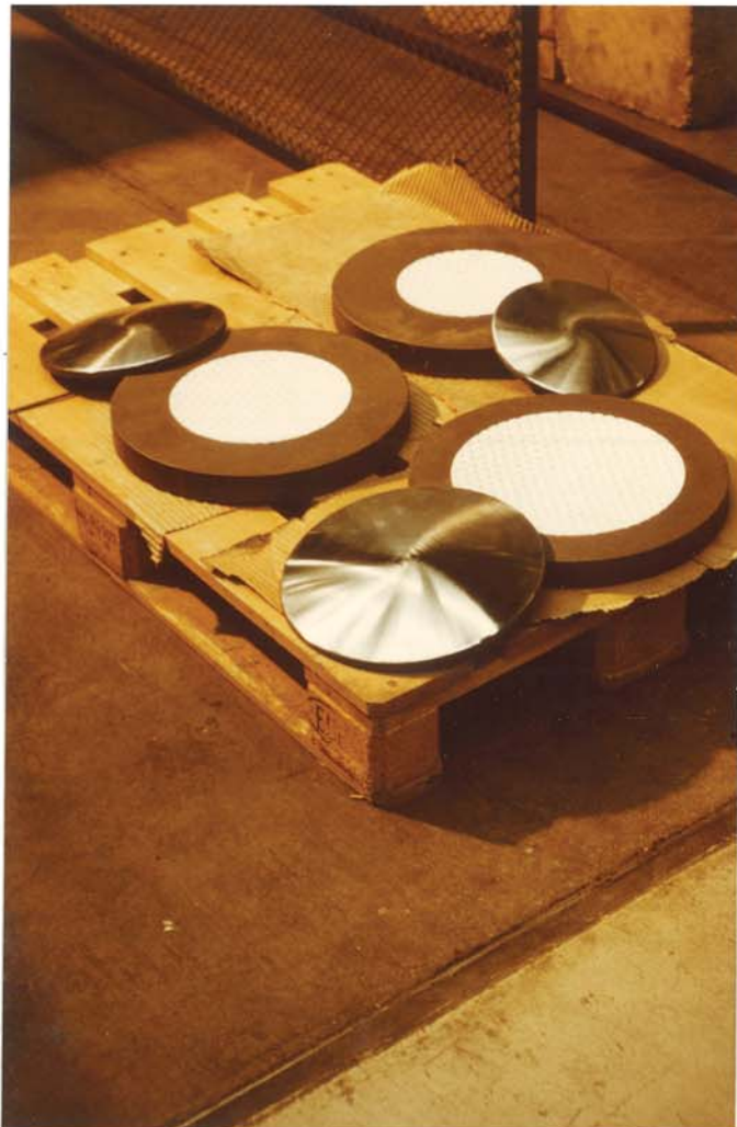
Bild 9 : Kalottenlager für die Versuche A 46 bis A 48 unmittelbar nach Anlieferung
