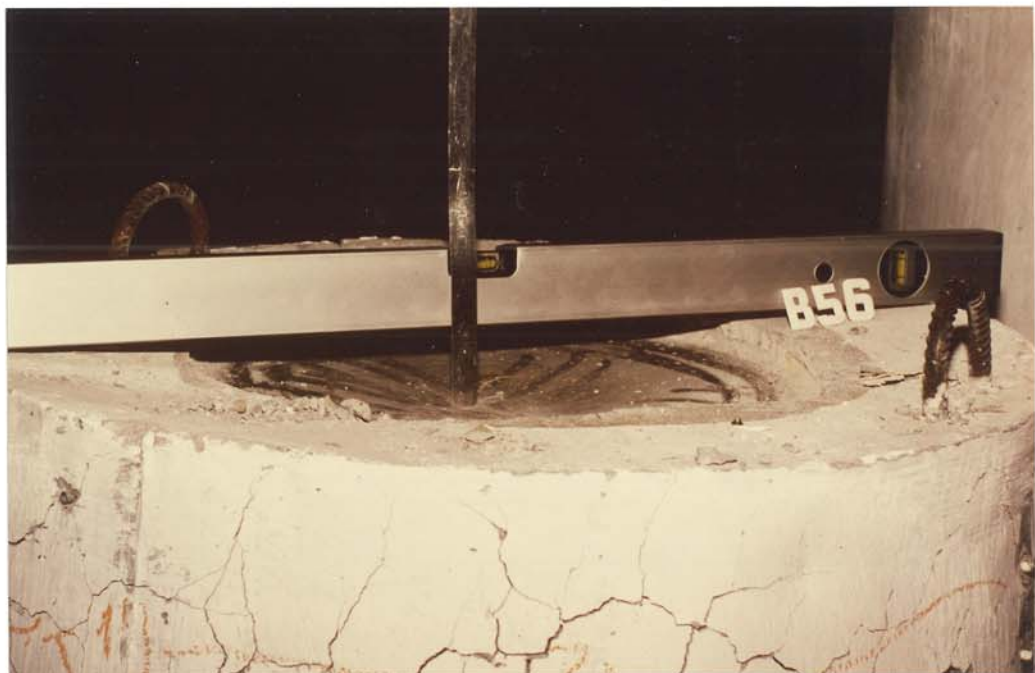
Bilder 25 und 26 : Stützenköpfe der Versuche B 53 (steife Lasteintragung) und B 56 (weiche Lasteintragung) nach Versuchsende; bei diesen Versuchen war nur eine dünne Ausgleichsschicht aus Kunstharzmörtel aufgezogen worden.
