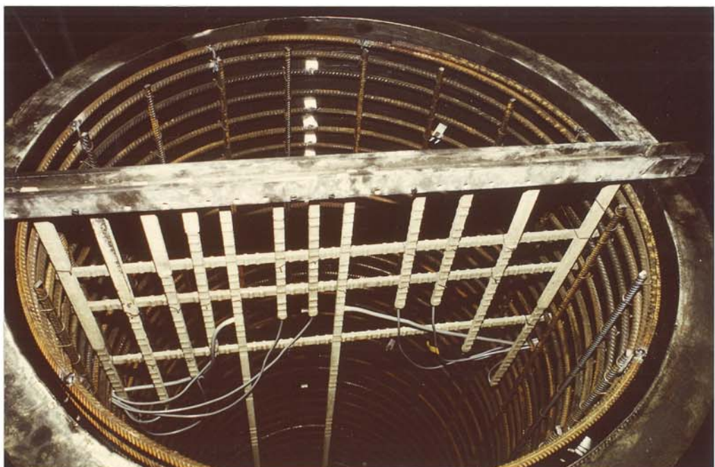
Bild 7: Betonzylinder \varnothing 980 mm für einen A-Versuch mit ein- gebauten Betoninnendehnungs- aufnehmern (BDA)
