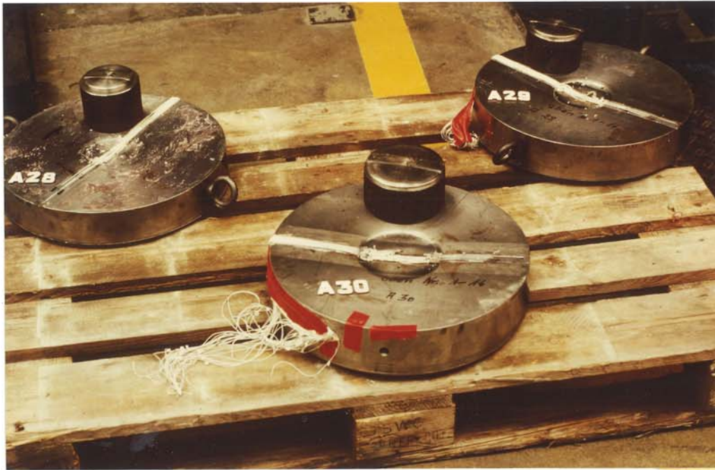
Bild 27 : Lagerplatten und Stahldruckstücke der Versuche A 28 bis A 30 nach Versuchsende mit deutlichen Eindrückungen auf den Platten und mit balligen, plastischen Randverformungen der Druckstücke
