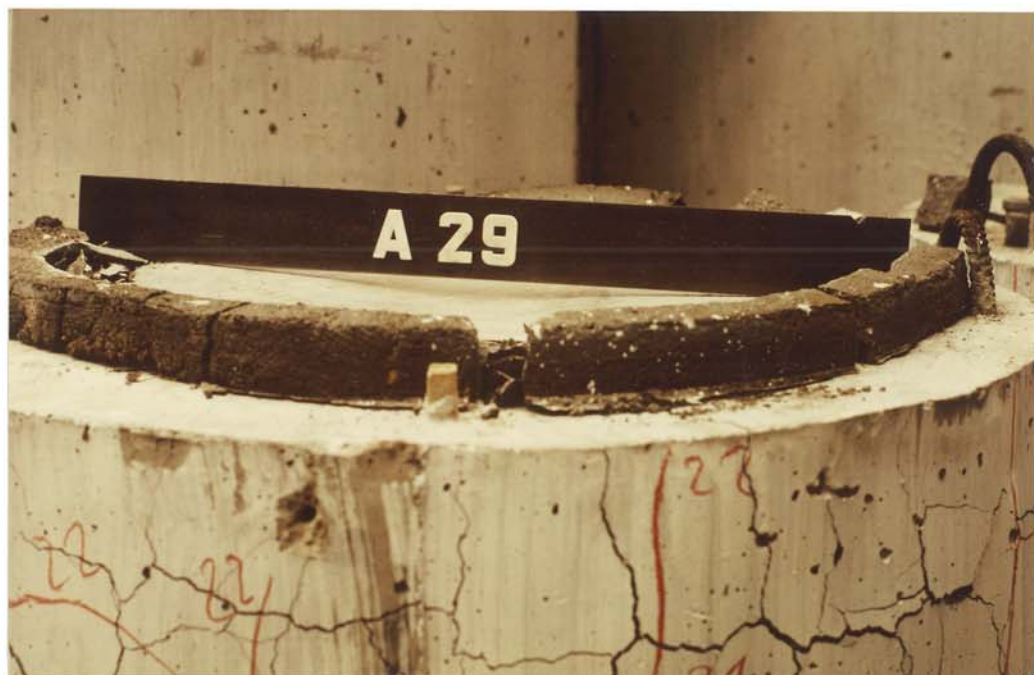
Bilder 21 und 22: Einstanzen der Lagerplatte bei steifer und bleibende Setzungsmulde bei weicher Lasteinleitung in einen Stahlbetonzylinder \varnothing 680 mm nach Versuchsende
