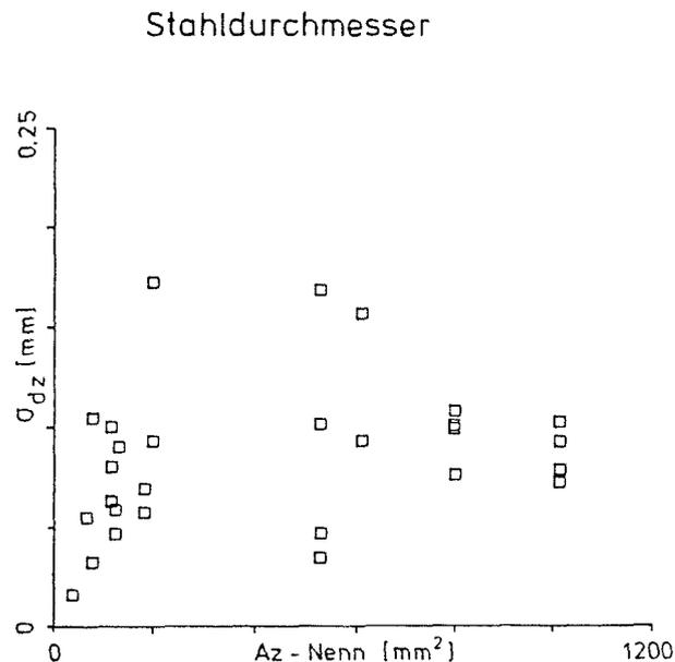
Bild 3.7: Standardabweichungen der unmittelbar geprüften Querschnittsabmessung
