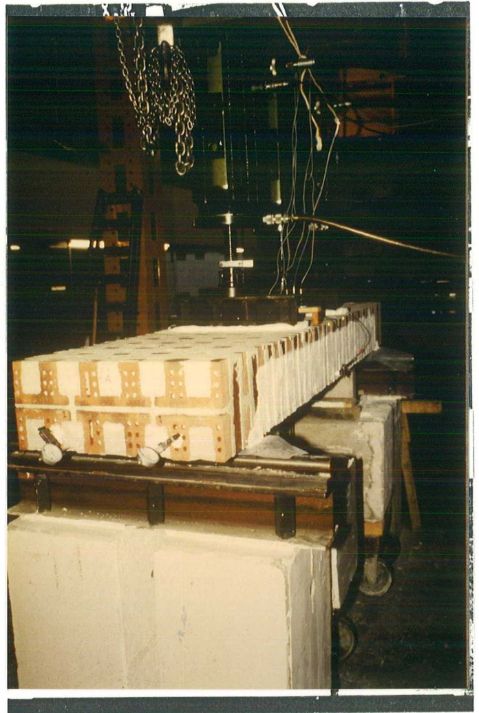
Foto 12 : Versuch II/4 Fugenversagen mit schlag - artigem Schlupfen des Stahles
