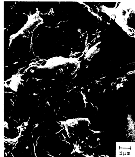
Bild 7. Rasterelektronenmikroskopische Aufnahme der Oberfläche eines PVC-Granulatkorner nach einer Versuchsdauer von 240 Tagen [13].
