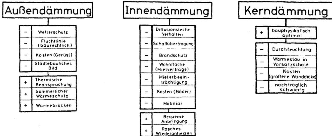
Schematische Darstellung der Vor- und Nachteile der Dämmschichtanordnung bei Außen-, Innen- und Kerndämmung, nach Gertis, 1982. Die Vorteile sind mit einem Pluszeichen, die Nachteile oder problematischen Aspekte mit einem Minuszeichen gekennzeichnet.
