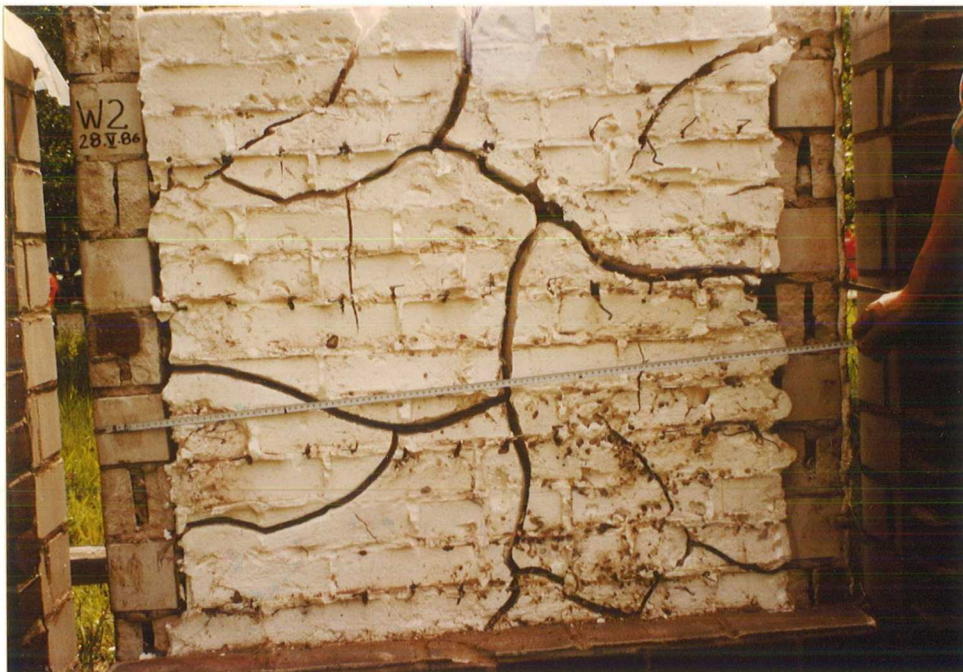
Bild 3: Teilansicht des UF-Schaumes "B" in Wand 2 nach Entfernen der Vormauerschale
