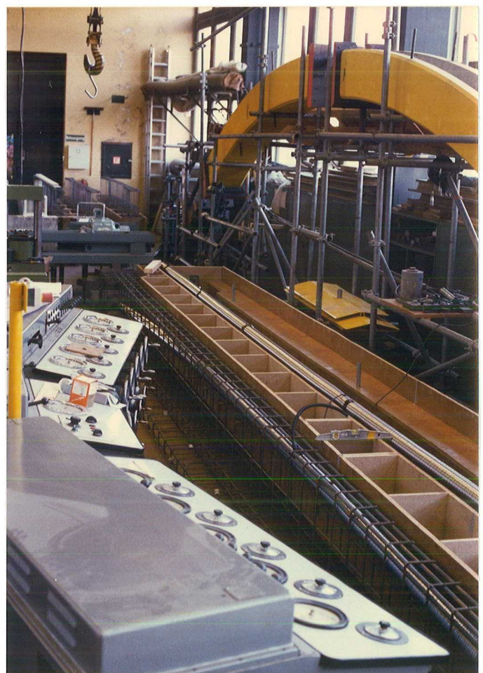
Bild 3.14: Aufbau der Schalung mit Bewehrung und Hüllrohr
