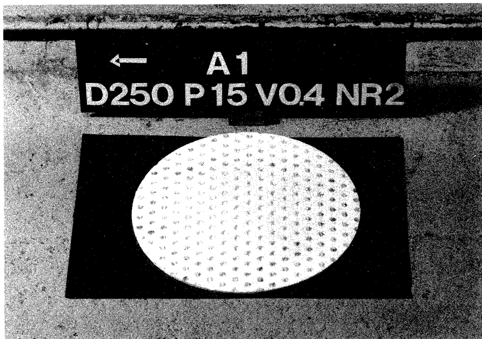
Bilder 7 und 8: Aust. Gleitblech und PTFE-Ronde nach 30 m Gleitweg (PTFE-Durchmesser 250 mm, Flächenpressung 15 N/mm 2 , Verschiebegeschwindigkeit 0,4 mm/s, Verschiebeweg \pm 75 mm)
