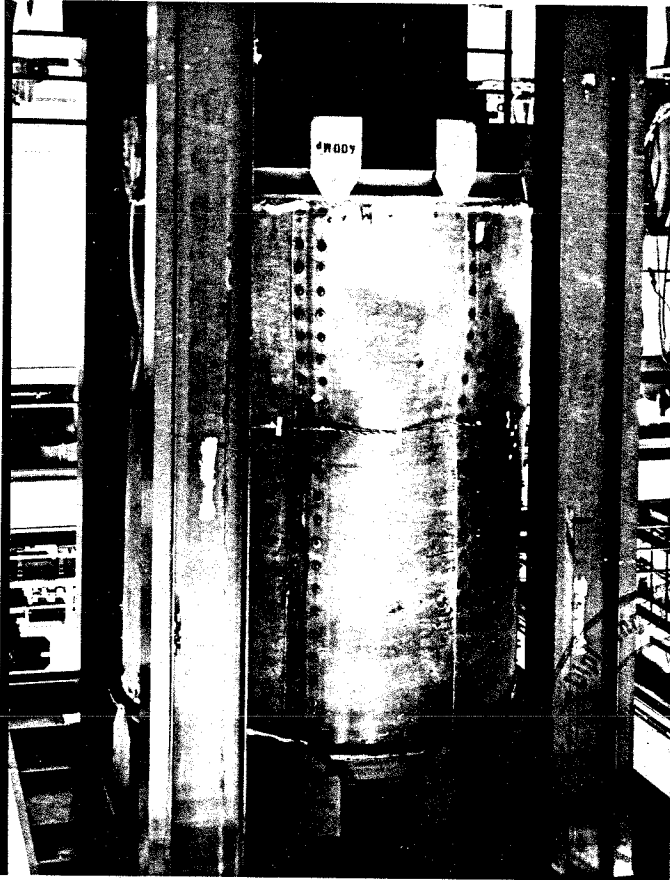
Bild 3 . Beulversuch (1971) an einer längsgedrückten Zylinderschale aus in axialer Richtung miteinander verschraubten Einzelsegmenten für Gärfuttersilos nach dem Durchschlagen /24, 39/
