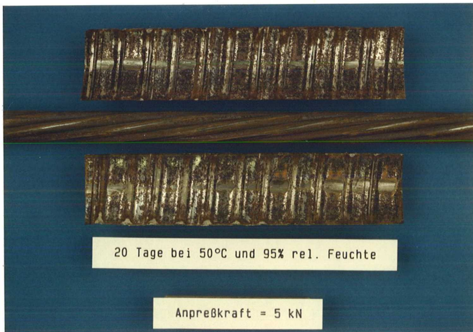
Bild 23: Korrosionsrate bei ungleicher Vorlagerungszeit
