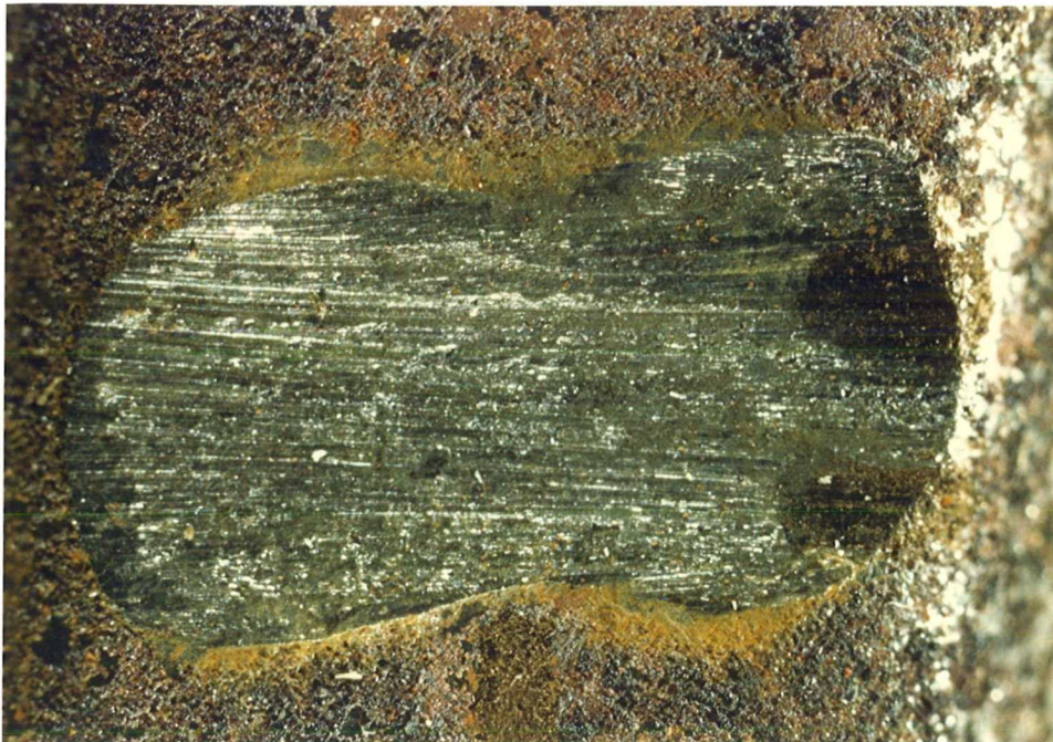
Bild 25: Untersuchte Reibspur für Rauhtiefenmessung
