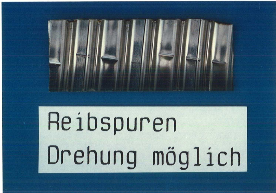
Bild 12: Reibspur bei Drehung der Litze
