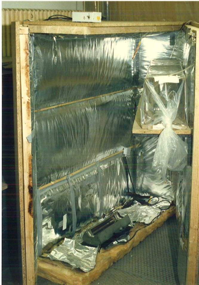
Bild 17: Klimazelle im geöffneten Zustand
