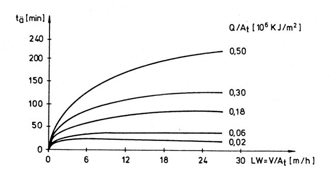
Bild 2 Äquivalente Branddauer  $t_{\ddot{a}}$  für Ölbrände mit natürlicher (oben) und Zwangsventilation (unten)
