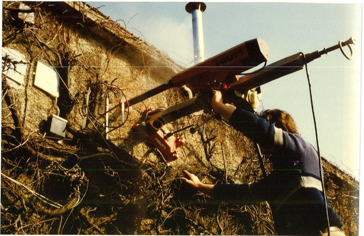
Bild 15 Trocken-Kernbohrung an der begrünten Fassade des Objektes Essen-Margarethenhöhe zur Bestimmung des Feuchteprofils im Wandquerschnitt (Bohrkerndurchmesser 10 cm).
