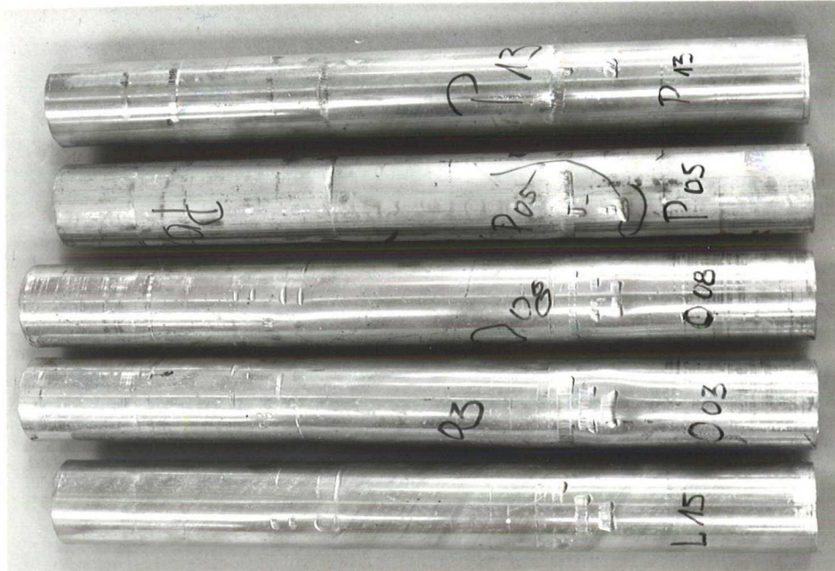
Bild 11. Rohre mit Rutschspuren nach den Versuchen mit Normalkupplungen
