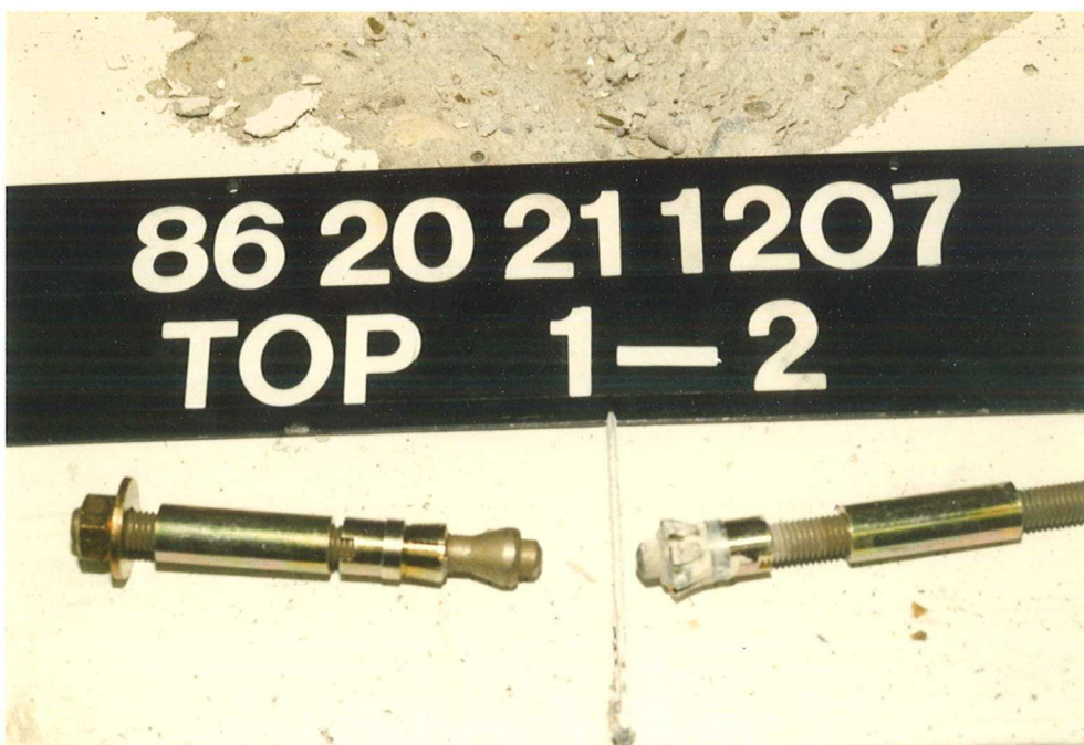
Bild 4.9: Upat TOP Hinterschneid-Anker M 12 vor und nach dem Versuch
