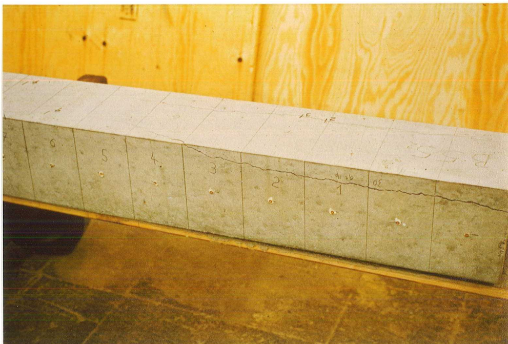
Balkenende mit Umschnürungsbewehrung
