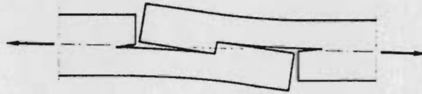
Bild 2.9 Verformungsfigur des geraden Hakenblatts ohne Verstärkung
