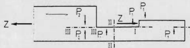
Bild 2.10 Zur Wirkungsweise des geraden Hakenblatts mit Verstärkung
