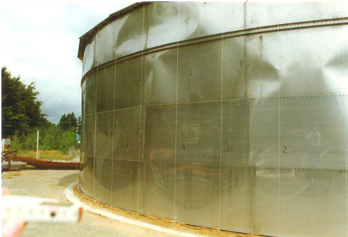
Bild 7.10: Beulbild bei einem Unterdruck von 37 mm WS (Behälter mit 1 Ringversteifung)
