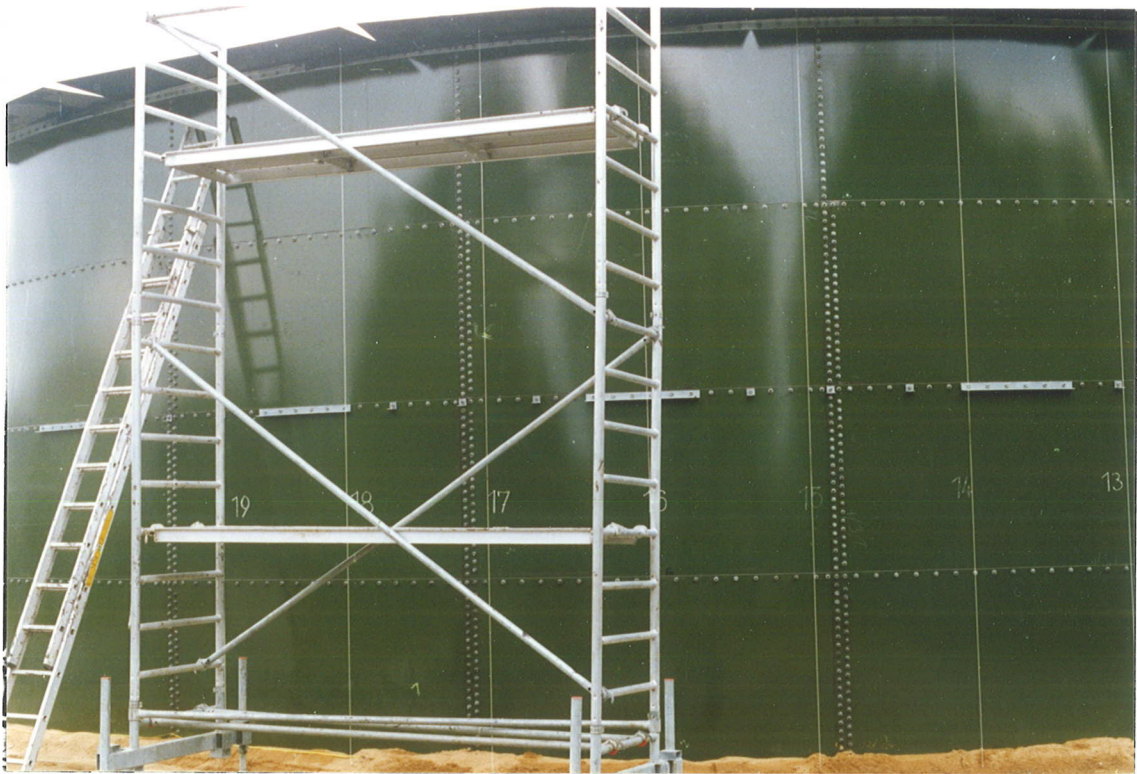
Bild 6.12: Beulbild bei einem Unterdruck von 37 mm WS (Behälter ohne Ringversteifung)
