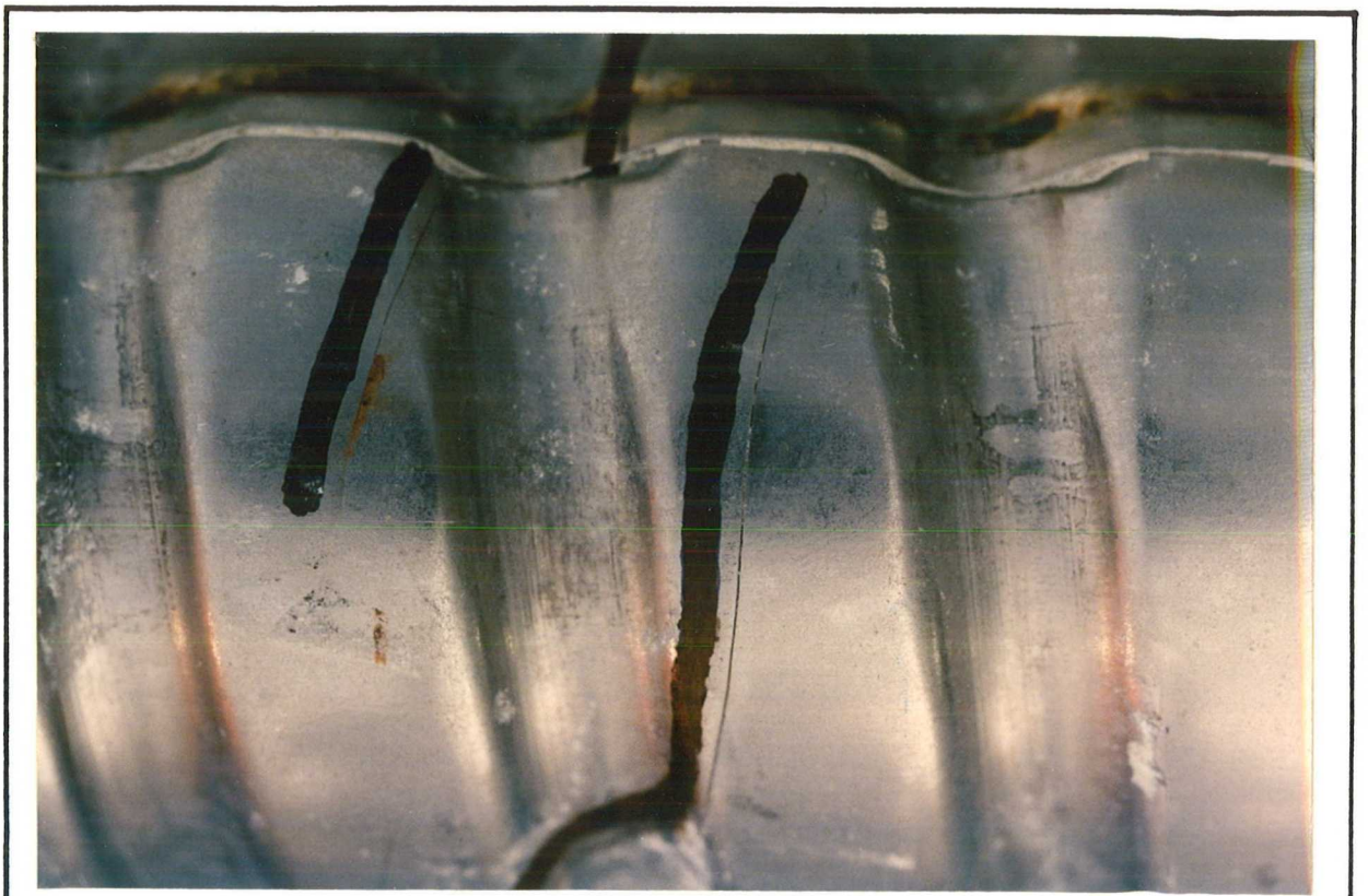
Ermüdungsriß: Hüllrohr - längsgeschweißt
