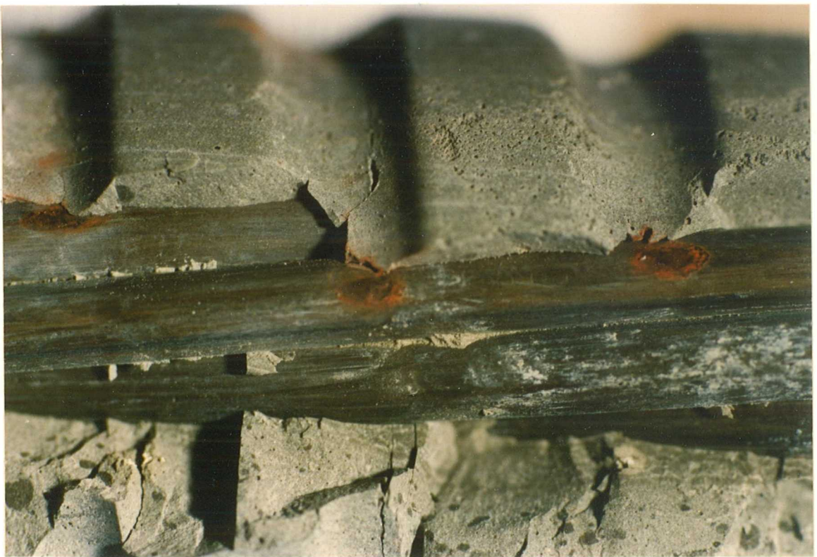
Reibstellen in der Kontaktzone Litze / Hüllrohr
