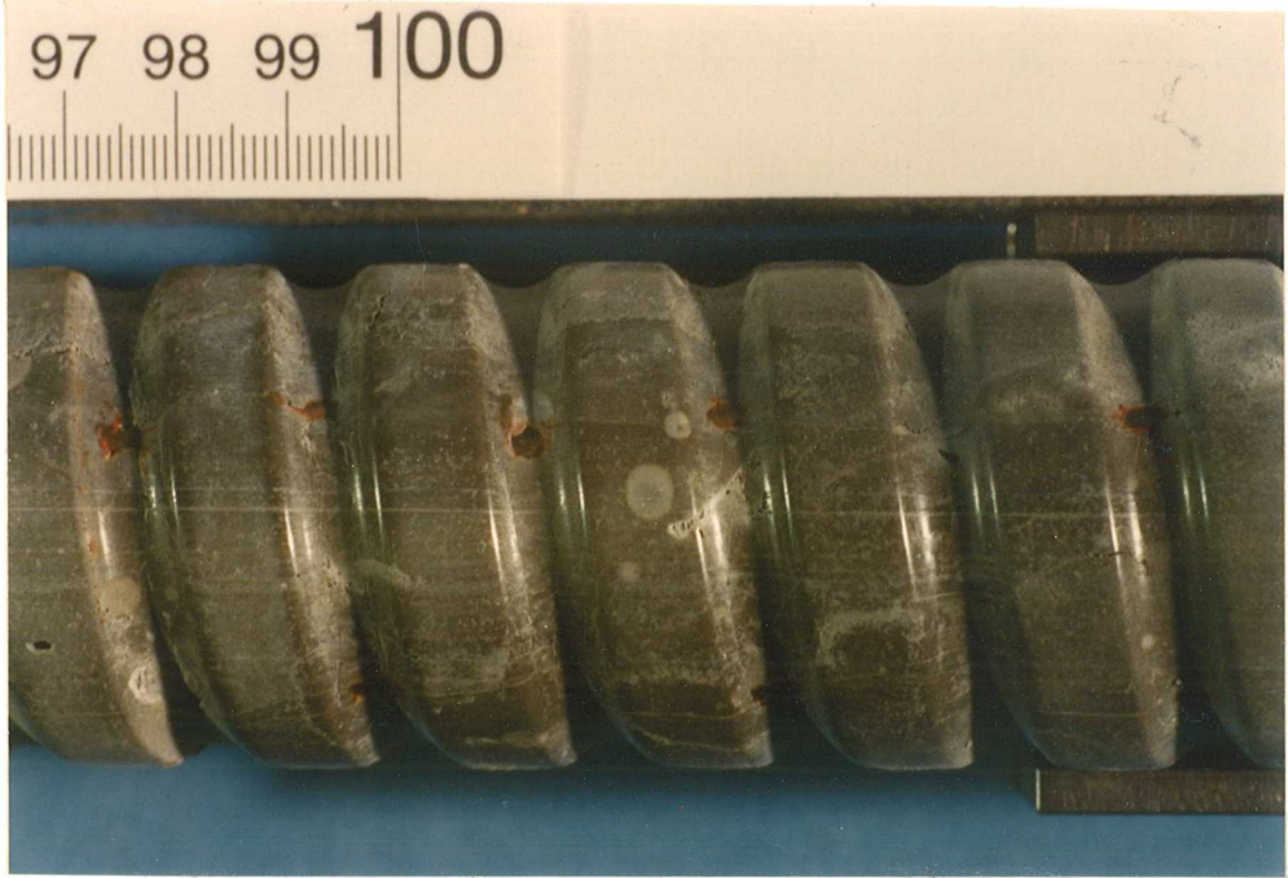
Reibkorrosion im Bereich zwischen den Betonrissen
