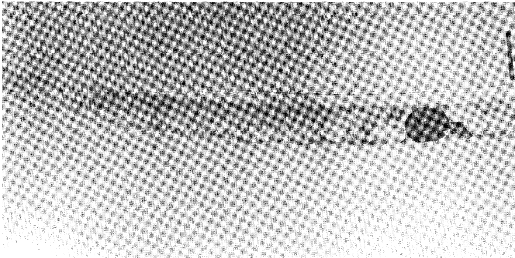
Bild 3.5: System 5 (EP/A-56-1L) nach 125.000 Übergängen mit dem Vulkollan-Rad und 200 Übergängen mit dem Polyamid-Rad (M = 1 : 1,2)
