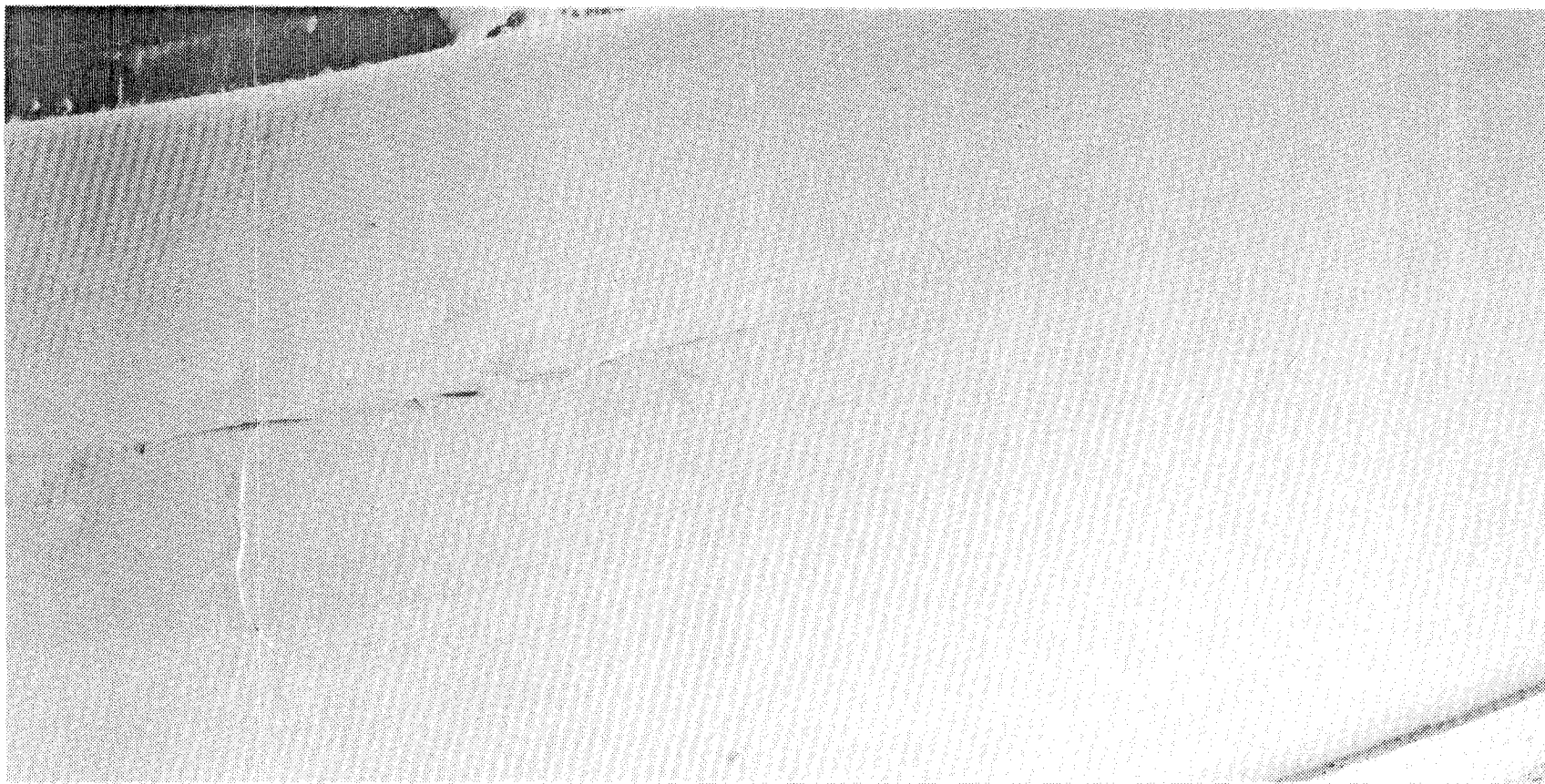
Bild 3.3: System 3 (EP/M-33-SL) nach wenigen ( < 10 ) Übergängen mit dem Vulkollan-Rad ( M = 1 : 1,4 )
