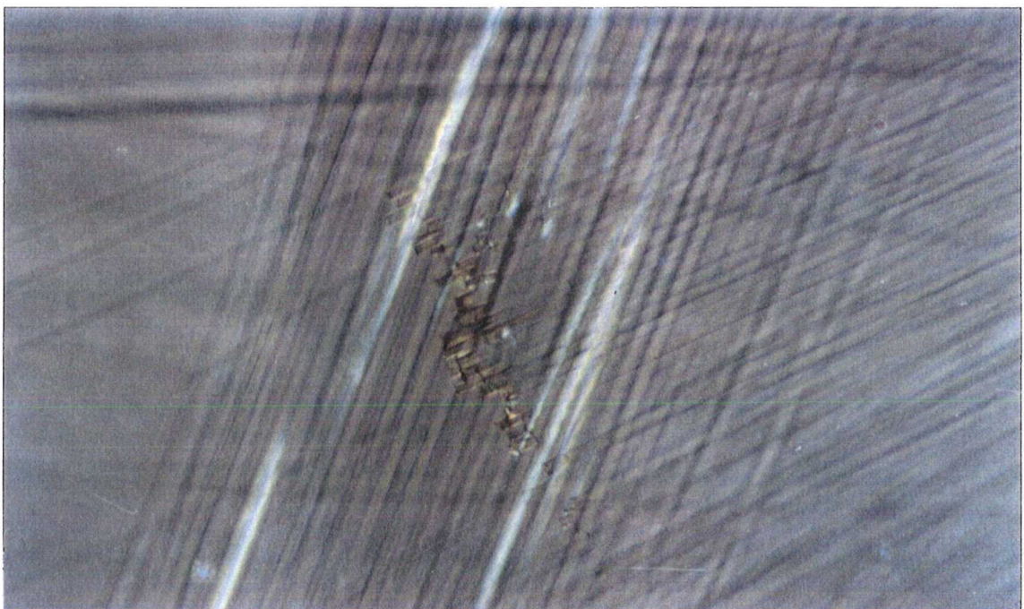
Bild 20: Fortgeschrittenes Schadensbild bei einer Dehnung der Probe von ca. 0,75 % im Lichtmikroskop (Vergrößerung: 200- fach)
