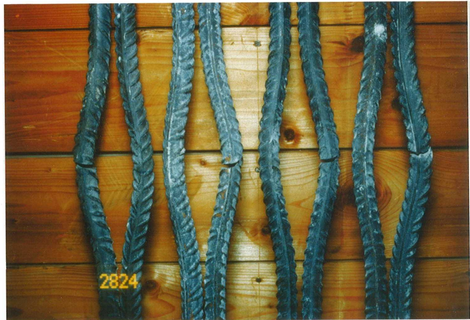
Photo 17: 2. und 3. Entwicklungsschritt Ansichten der Dauerschwingbrüche
