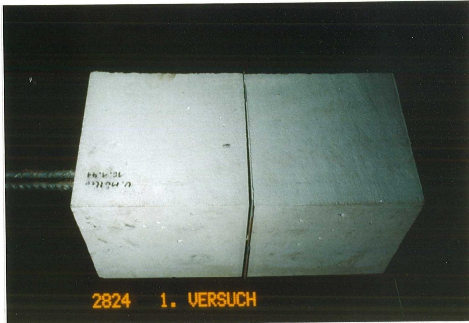
Photo 6: 2. Entwicklungsschritt / Versuchskörper nach Beendigung des Dauerschwingversuchs
