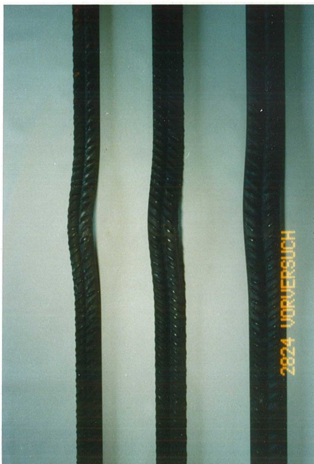
Photo 9: 3. Entwicklungsschritt / Stabstahlpaare nach dem Biegen in der Biegevorrichtung
