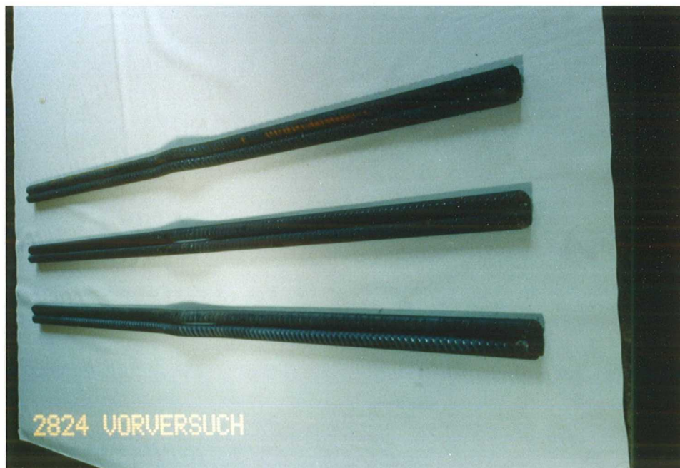
3. Entwicklungsschritt / Stabstahlpaare nach dem Biegen in der Biegevorrichtung (die Stabenden wurden hierfür verschweißt)
