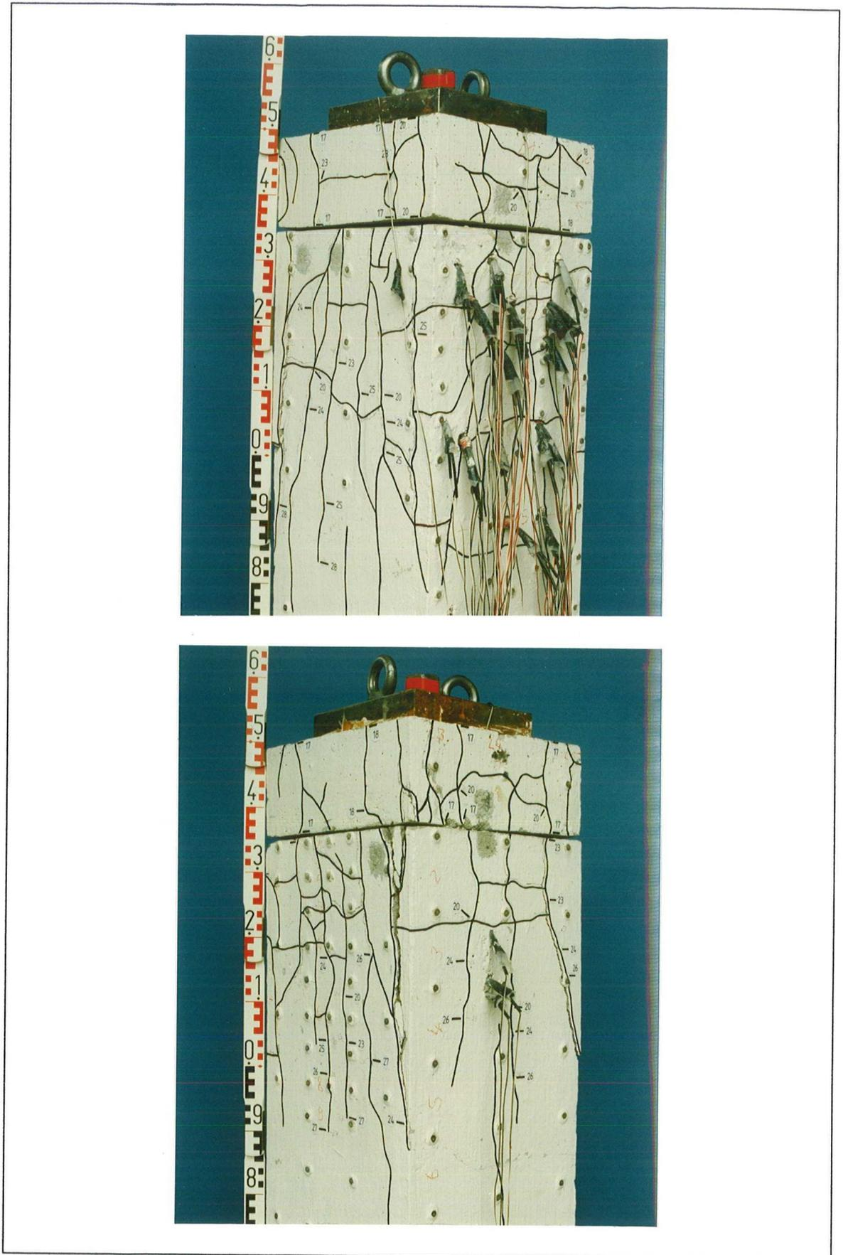
Bild 7.9: Versuchsstütze 9 nach Versuchsende.
