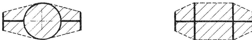
Bild 4.14: Fußfläche  $A_s$  für Stahlpfähle mit Flügeln am Pfahlfuß
