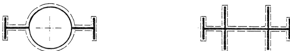
Bild 4.15: Mantelfläche  $A_m$  im Bereich der Flügel
