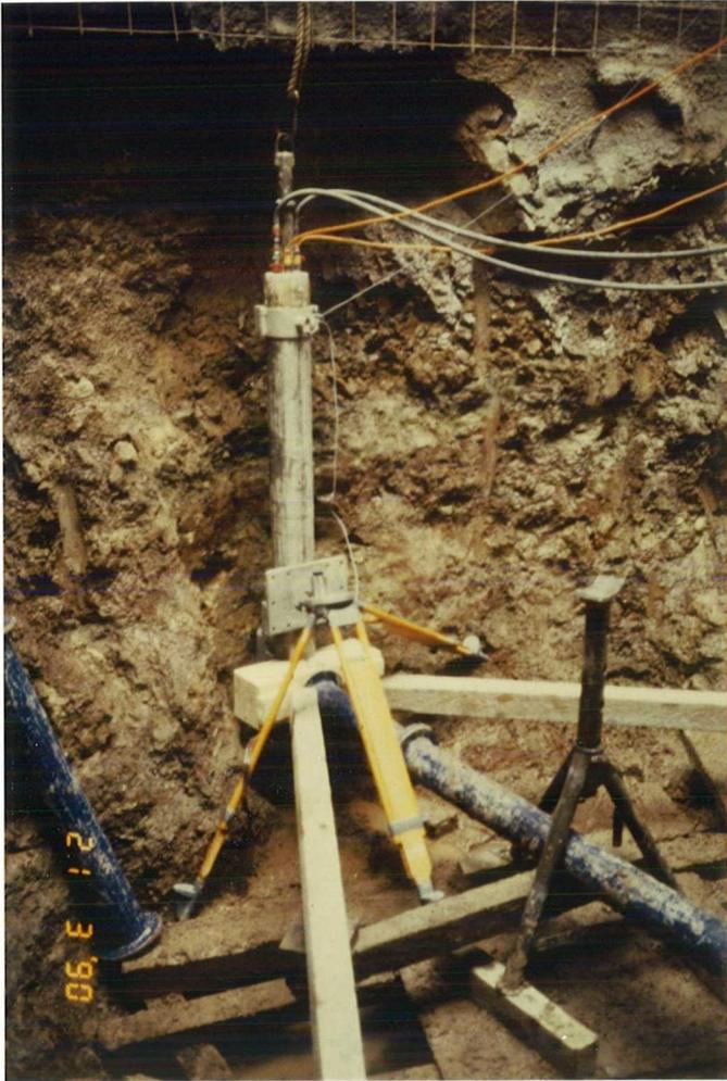
Abbildung 31: Seitendrucksondierung mit der im Brunnen verspannten Sonde.
