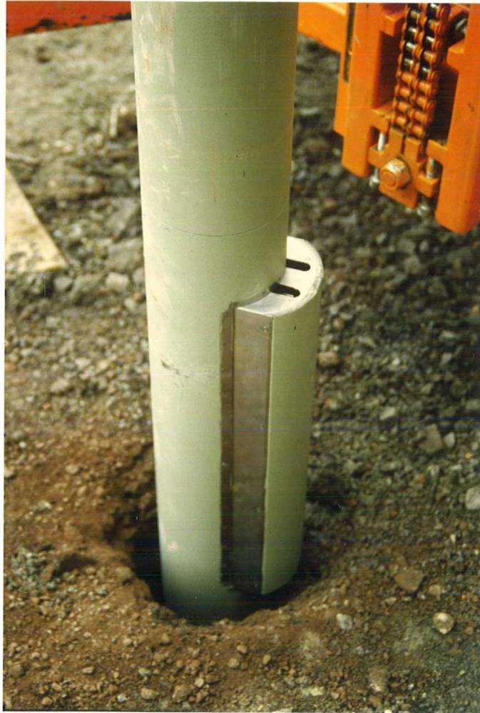
Abbildung 15: Karlsruher Seitendrucksonde mit ausgefahrener Druckplatte
