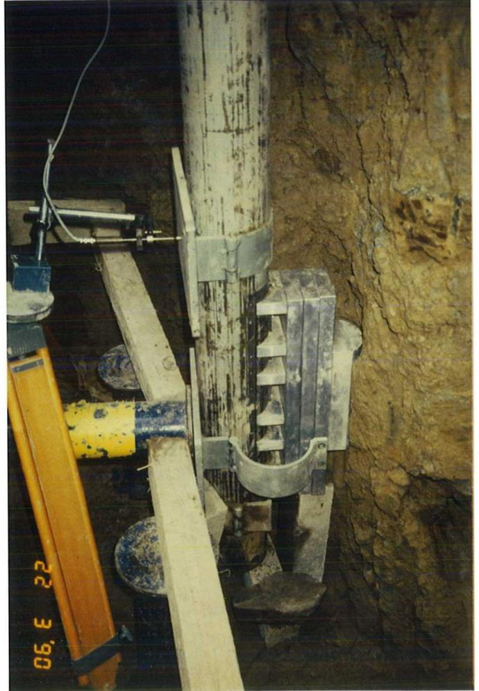
Abbildung 32: Die Druckplatte der Sonde liegt am anstehenden Gipskeuper an.
