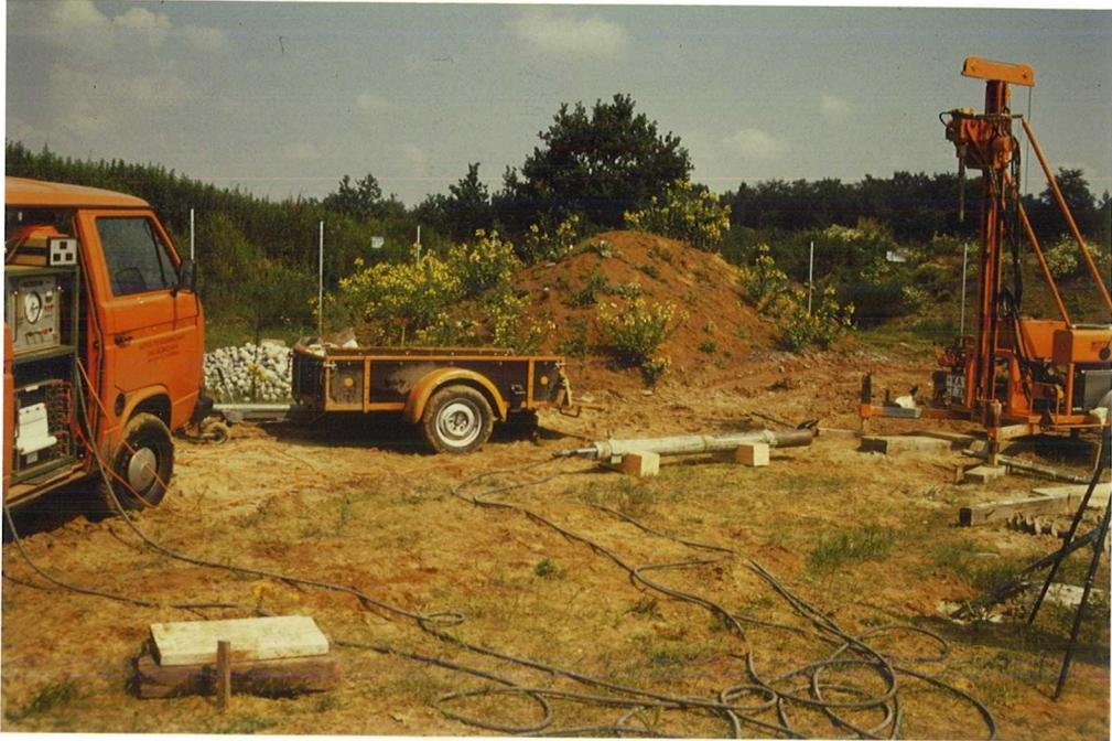
Abbildung 13: Karlsruher Seitendrucksonde, Meßeinrichtung und Bohrgerät
