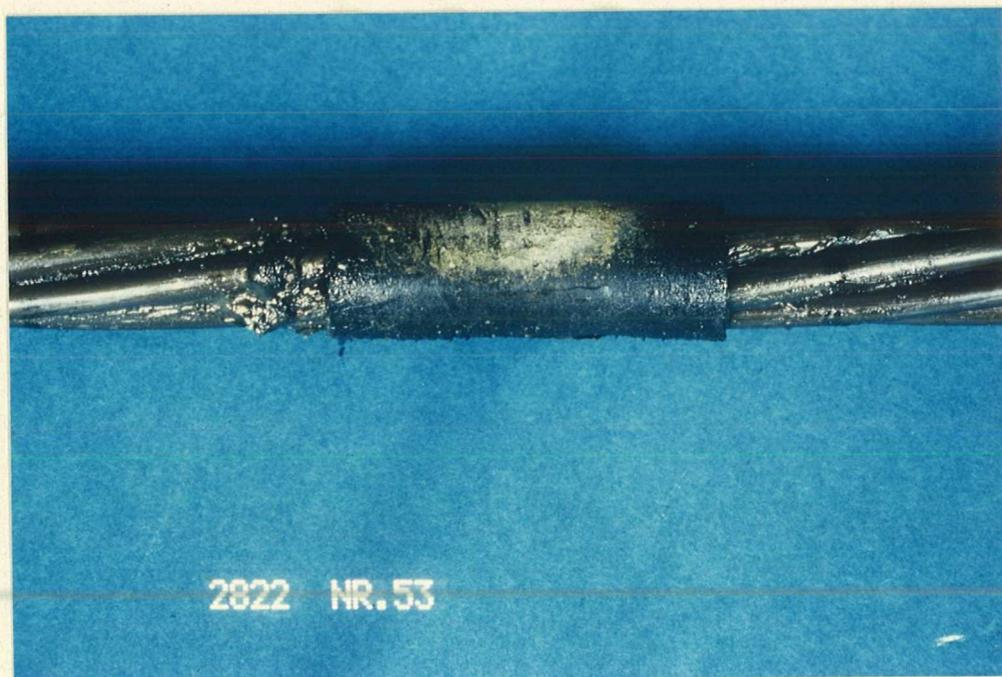
Bild 9: PE-Hüllrohr, Außenseite, Anpreßstelle an das Mörtelbett
