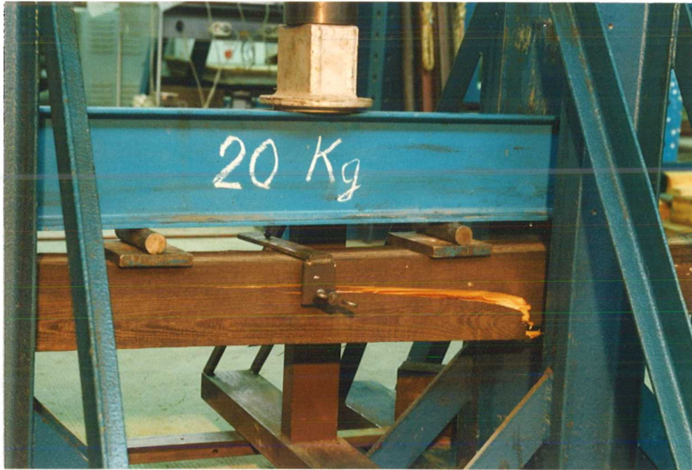
Bild 7 Die hydraulisch erzeugte Prüfkraft wird mit Hilfe einer Stahltraverse auf die im Abstand von 4 \times H angeordneten Krafteinleitungspunkte verteilt (Prüfbereich). Die Kräfte werden über Rollen und Reiter aus Stahl in den Prüfkörper eingeleitet.
