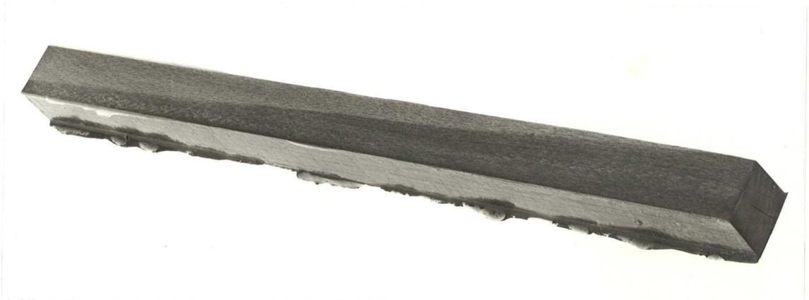
Anhang 3.4: Foto einer 5-seitig abgedichteten Axialprobe mit Faserabweichung, Holzart: Buche Splint. (Die oberseitige Epoxidharzabdichtung wurde nach der Tränkung entfernt.)
