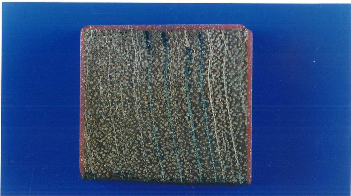
Anhang 3.6: Foto einer getränkten Tangentialprobe von Dark-Red-Meranti. Geringe mittlere Eindringtiefe (unten), jedoch maximale Eindringtiefe entlang einiger tangentialer Harzkanal-Parenchymbänder (vertikal verlaufend), mit Stau von Tränkmittel am Probenende (oben), als Ursache für die höheren Aufnahmen.
