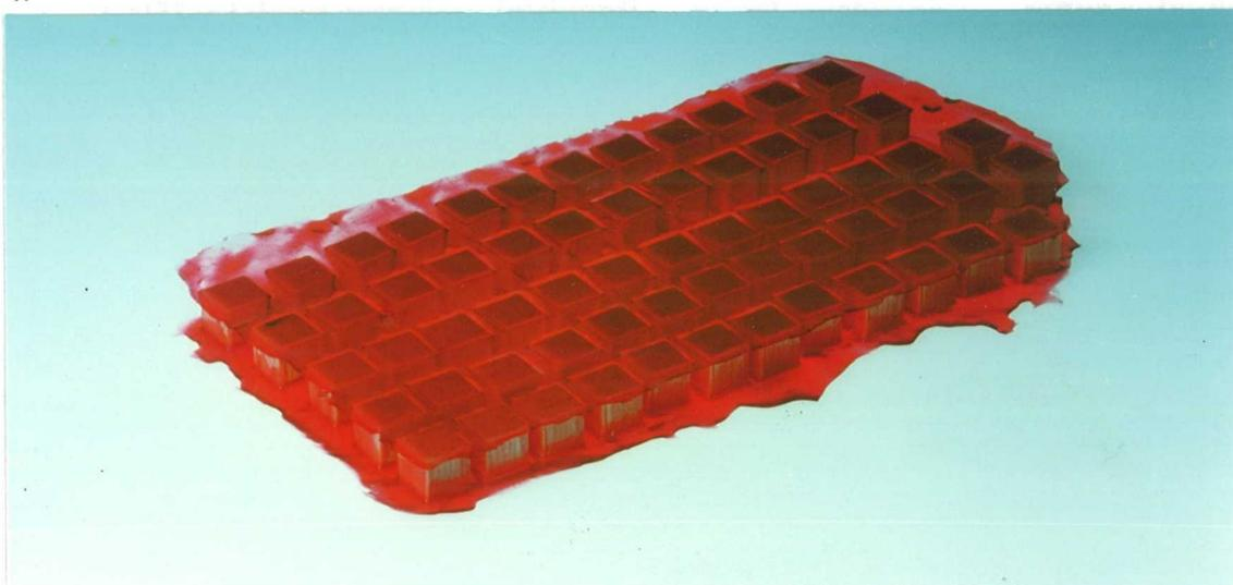
Anhang 3.1: Foto von eingeharzter Probeneinheit auf Polyethylenfolie
