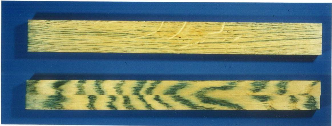
Anhang 3.12 Foto von 2 aufgeschnittenen IUFRO-Probenhälften. Holzart: Eiche Kern, links Eindringfront, rechts Probenmitte, oben Radialschnitt, unten Tangentialschnitt. Gefäße durchtränkt, übriges Grundgewebe nicht durchtränkt.
