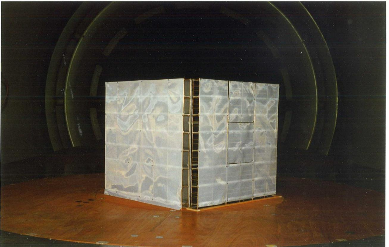
*Bild 45:* Gebäude mit allseitigem Gerüst
