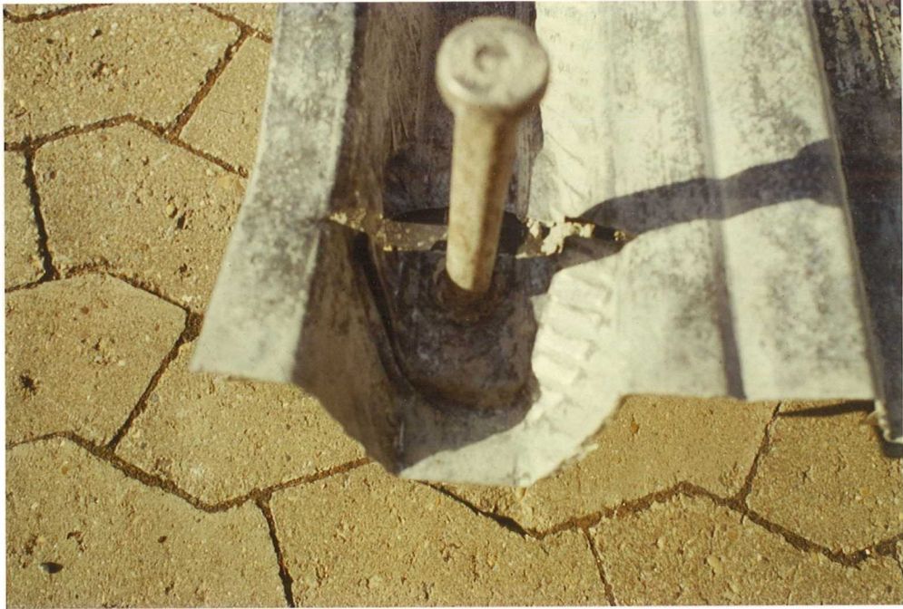
Bild A.2.5: Deutlicher Blechriß vor dem Kopfbolzendübel nach Zerlegung des Versuchskörpers (COF5)
