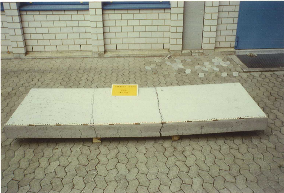
Bild A.2.2: Typisches Rißbild bei Versuch mit mittlerer Schublänge (Versuch COF5)
