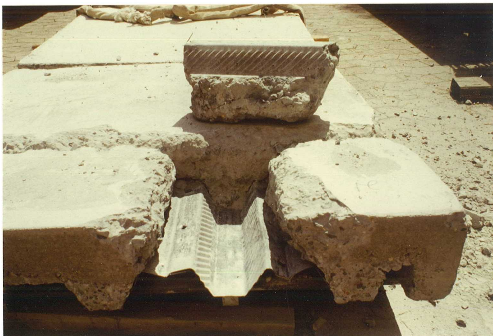
Bild A.2.4: Unzerstörte Betonrippe nach Zerlegung des Versuchskörpers (COF5)
