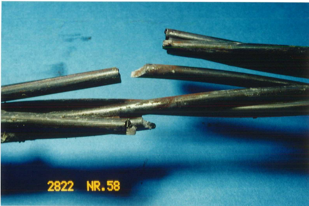
Bild 28: Spanndrahtlitze mit Drahtbrüchen an der Reibstelle Probe PE-M-L 4 : Reibweg 0,20 mm Anpreßkraft 60 N/lfmm
