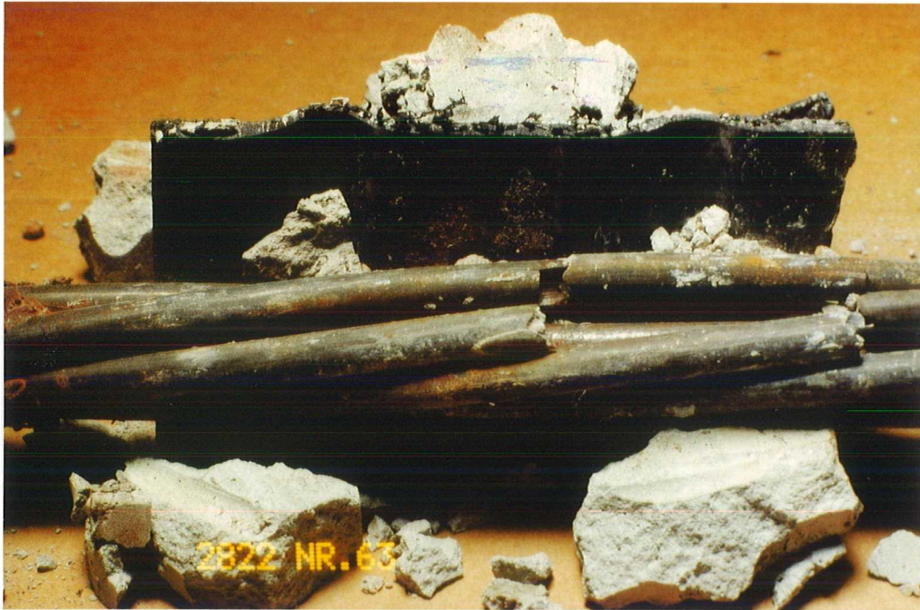
Bild 30: Bruch einer Spanndrahtlitze mit geöffneter Reibstelle Probe PP-M-L 1 : Reibweg 0,23 mm Anpreßkraft 60 N/lfmm
