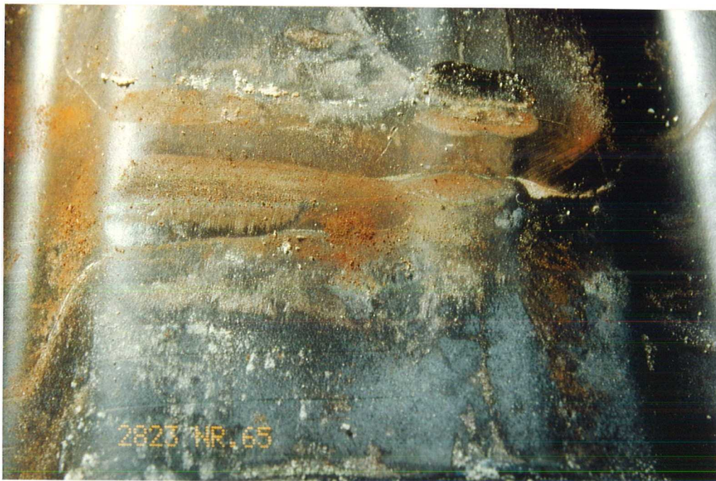
Bild 33: Detail einer Reibstelle am PP Hüllrohr Probe PP-M-L 4: Reibweg 0,20 mm Anpreßkraft 120 N/mm (!)
