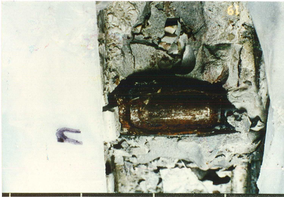
Bild 38: Bruch eines glatten Spanndrahts mit geöffneter Reibstelle Probe ST-M-G 16 : Reibweg 0,10 mm Anpreßkraft 50 N/lfmm
