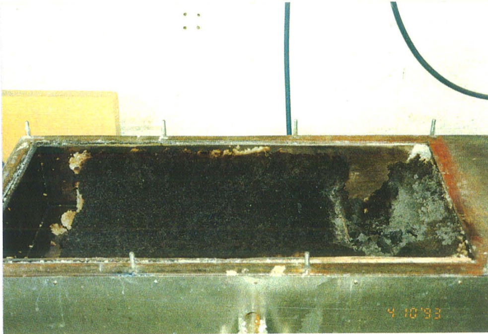
Foto 9: Zelluloseflocken B 1 (Versuch 13) geöffneter Deckel (nach ca. 4 h)
