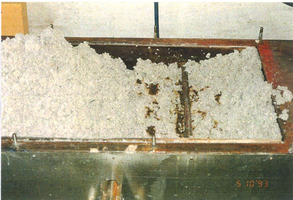
Foto 10: Zelluloseflocken B 1 (Versuch 15) geöffneter Deckel (nach ca. 4 h)
