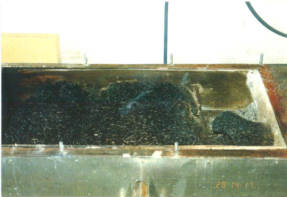
Foto 7: Hanfstroh bituminiert (Versuch 5) geöffneter Deckel (Abbruch nach ca. 20 h)
