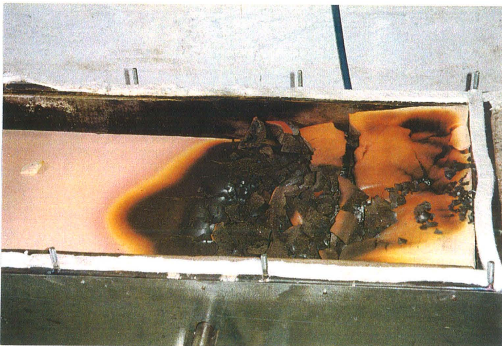
Foto 14: Phenolharz-Hartschaum (Versuch 23) Platten bis zum Heizstab entfernt (nach ca. 22 h)
