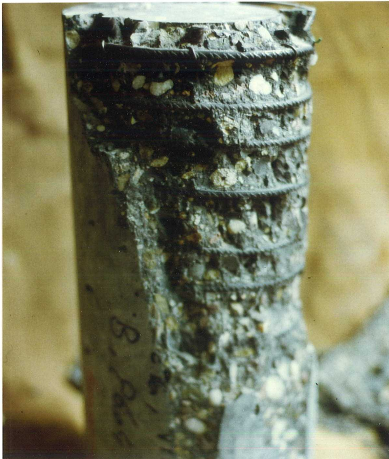
Bild A 15: Versagen nach Überschreiten der Höchstlast ohne Spalten, Versuchskörper der Reihe 3, Serie 3
