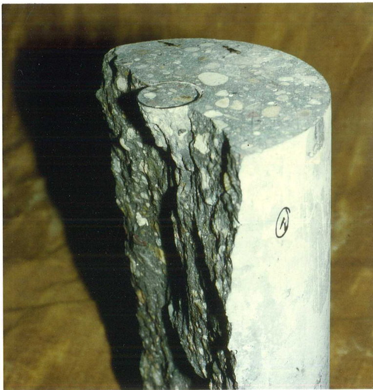
Bild A 9: Ausbruchkegel bei Stempeldurchmesser 40mm, Versuchskörper der Reihe 2.1, Serie 2
