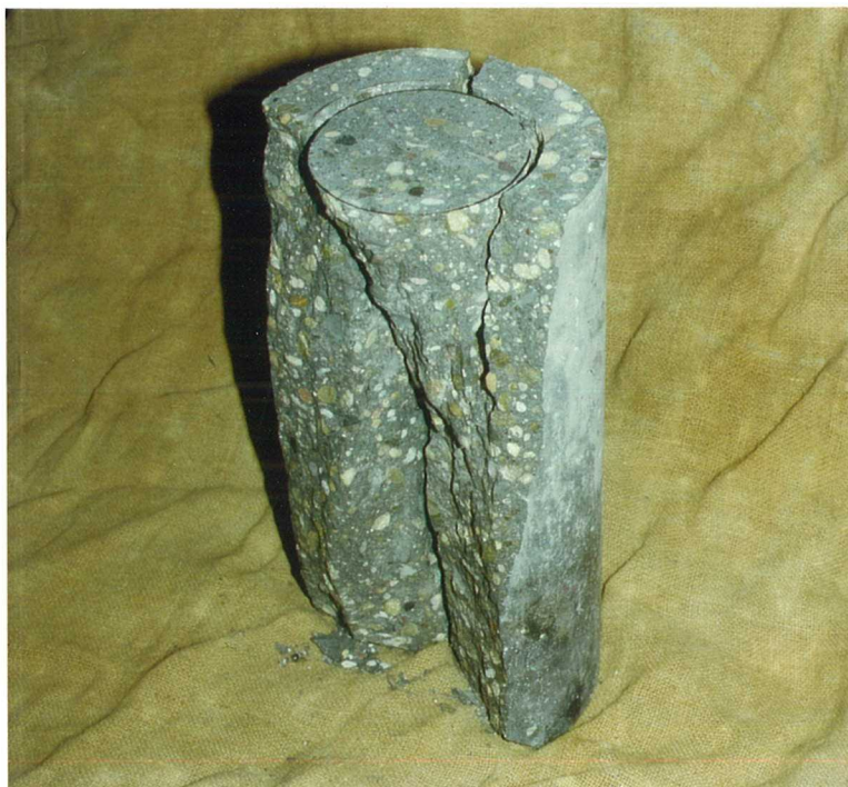
Bild A 11: Ausbruchkegel bei Stempeldurchmesser 120mm, Versuchskörper der Reihe 2.1, Serie 1
