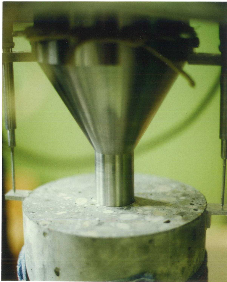
Bild A 1: Prinzip der Teilflächenbelastung
