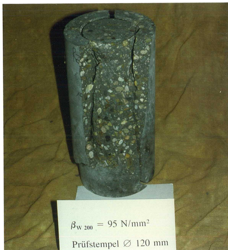
Bild A 7: Versagen durch Spalten, Versuchskörper der Reihe 2.1, Serie 1
