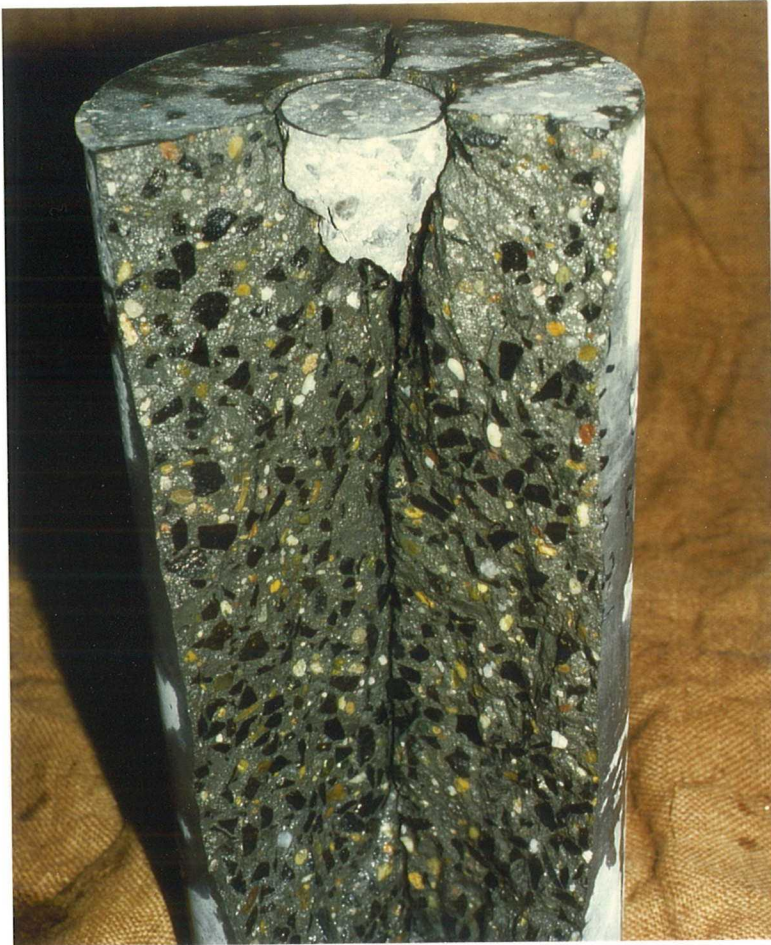
Bild A 10: Ausbruchkegel bei Stempeldurchmesser 60mm, Homogenes Betongefüge in der Spaltfläche, Versuchskörper der Reihe 1, Serie 3
