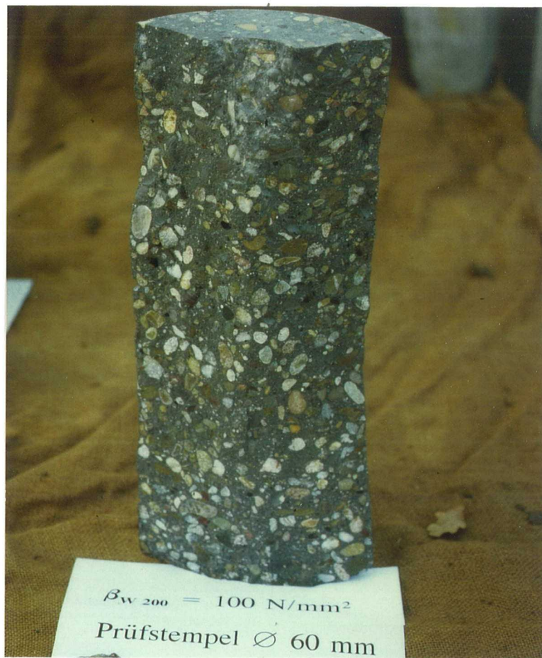
Bild A 12: Homogenes Gefüge in der Spaltfläche, Versuchskörper der Reihe 1, Serie 2
