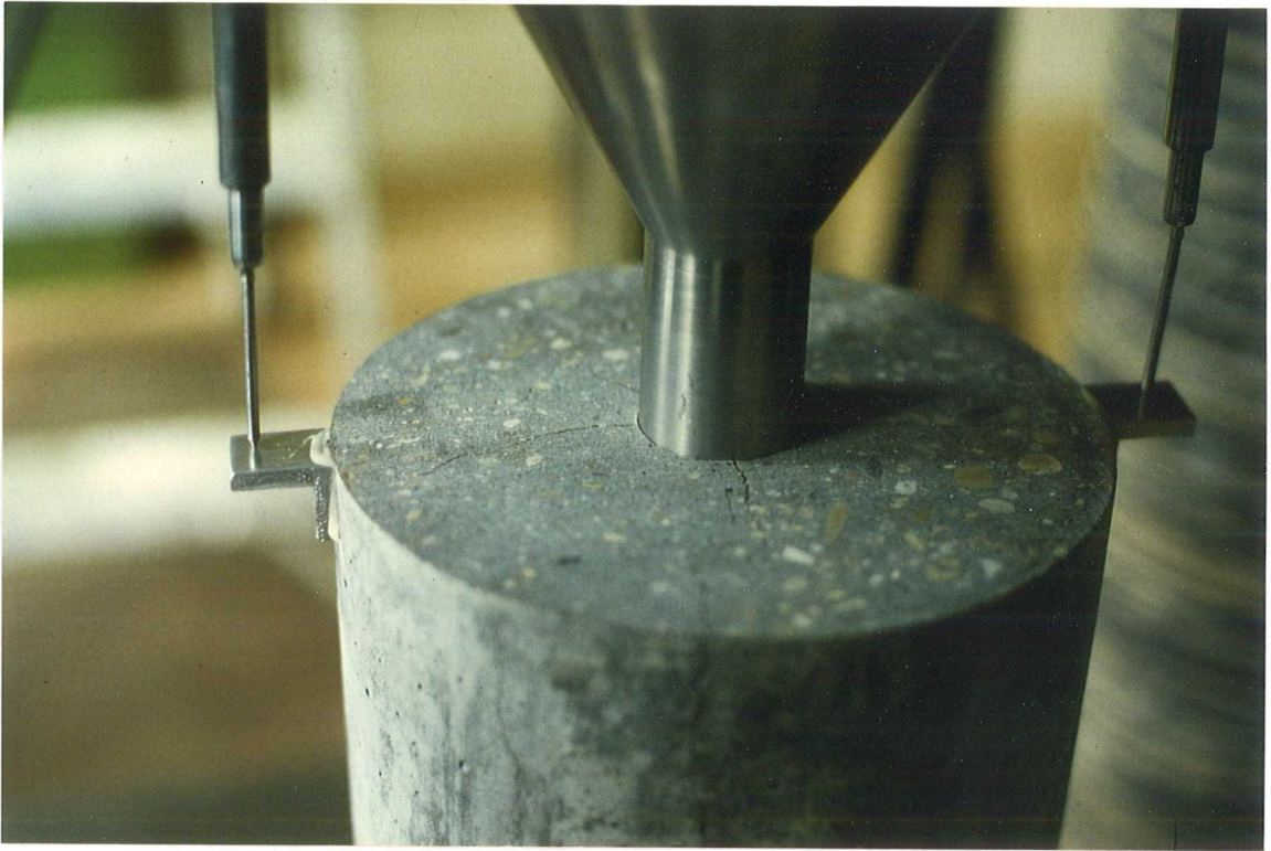
Bild A 18: Rißbildung und -ausbreitung, Versuchskörper der Reihe 3, Serie 1
