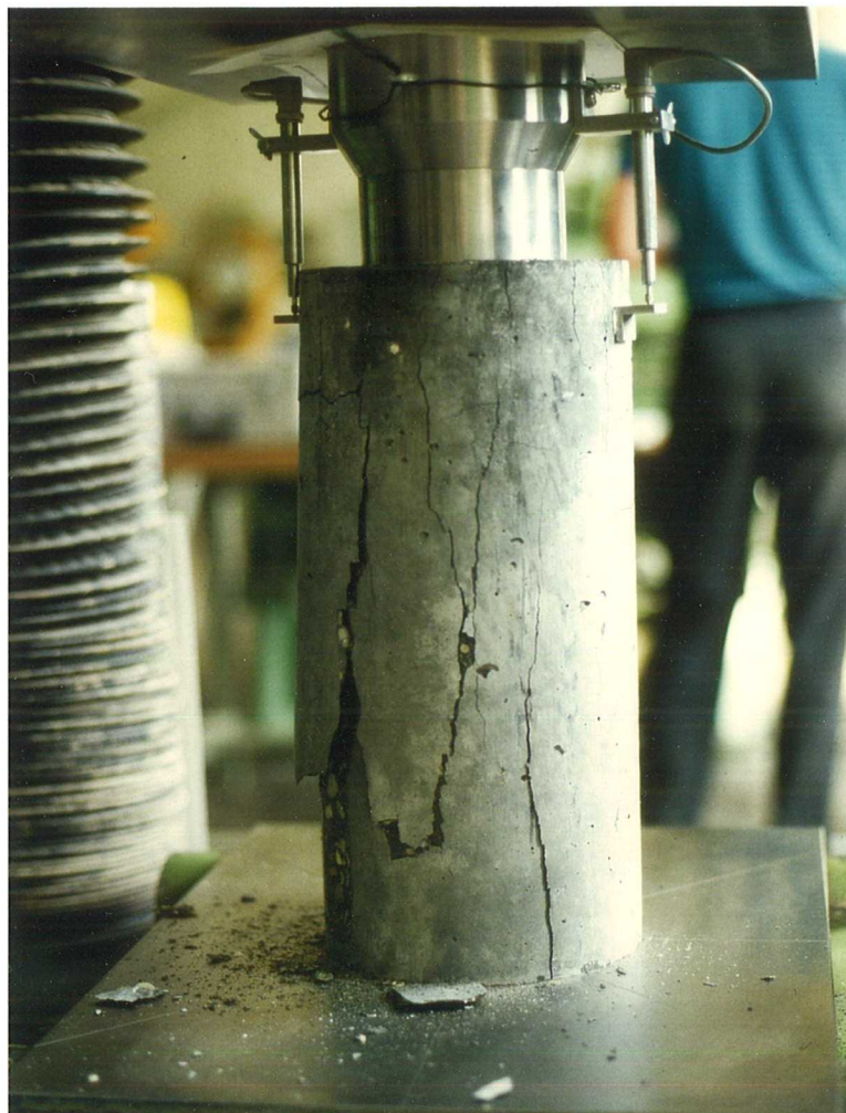
Bild A 21: Abplatzung der Betondeckung während des Versuches, Versuchskörper der Reihe 3, Serie 3
