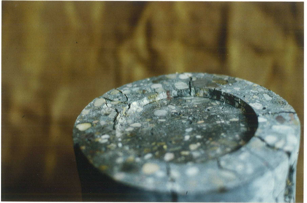
Bild A 16: Eindringung des Laststempels ohne Spalten, Versuchskörpers der Reihe 3, Serie 3
