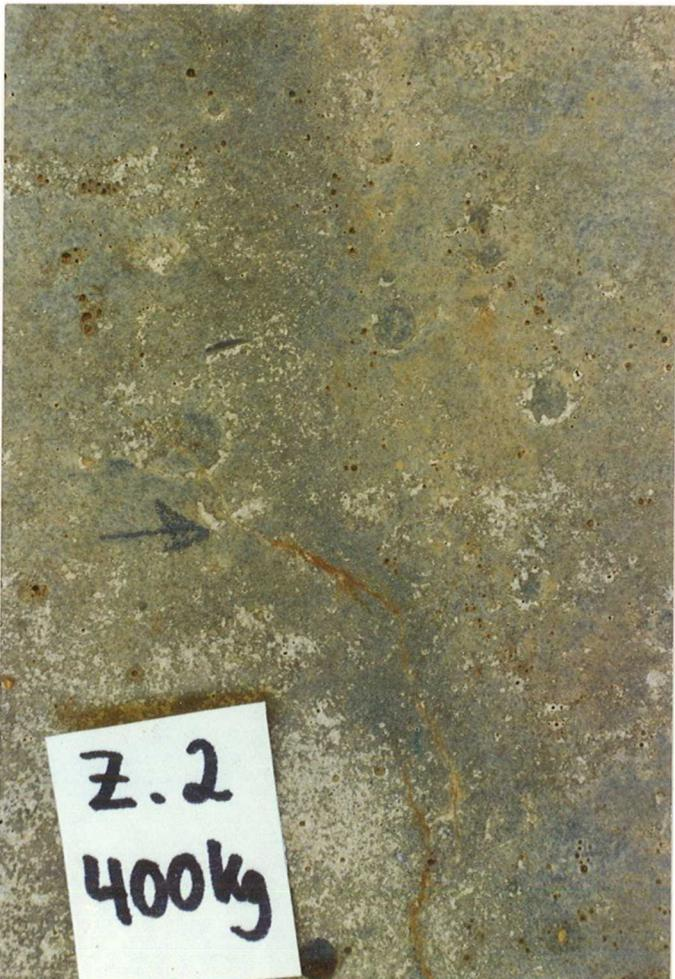
Würfel (30 cm Kantenlänge) während der Nebelkammerlagerung
