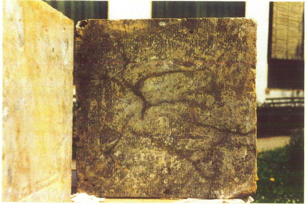
Abb. 9 (Neg. 23), V 8, Seitenfläche, rechte Kante zur Oberseite gehörig; 390 d Netzrißsystem
