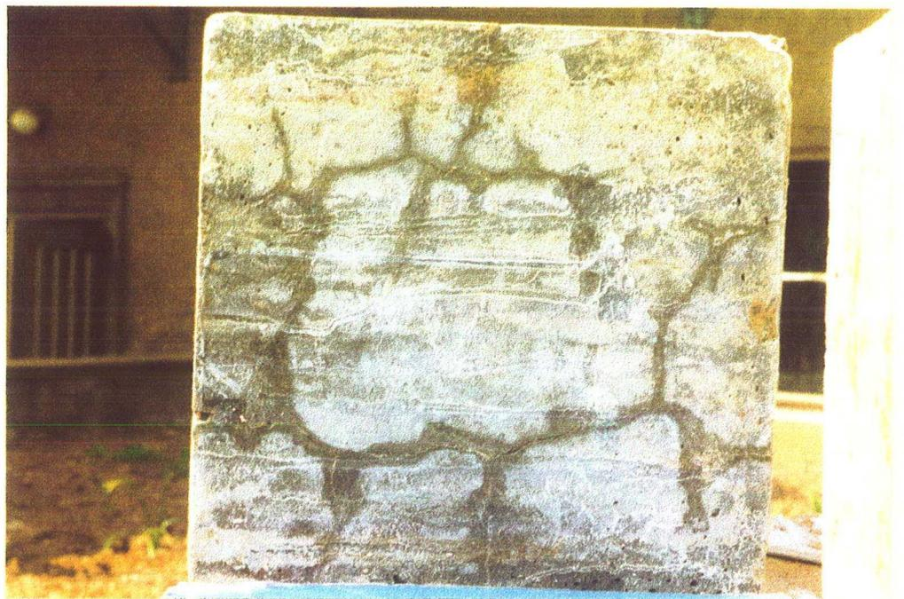
Abb.10 (Neg. 24), V 8, Basisfläche (wie Abb. 7, aber weiter abgetrocknet), 390 d Netzrißsystem
