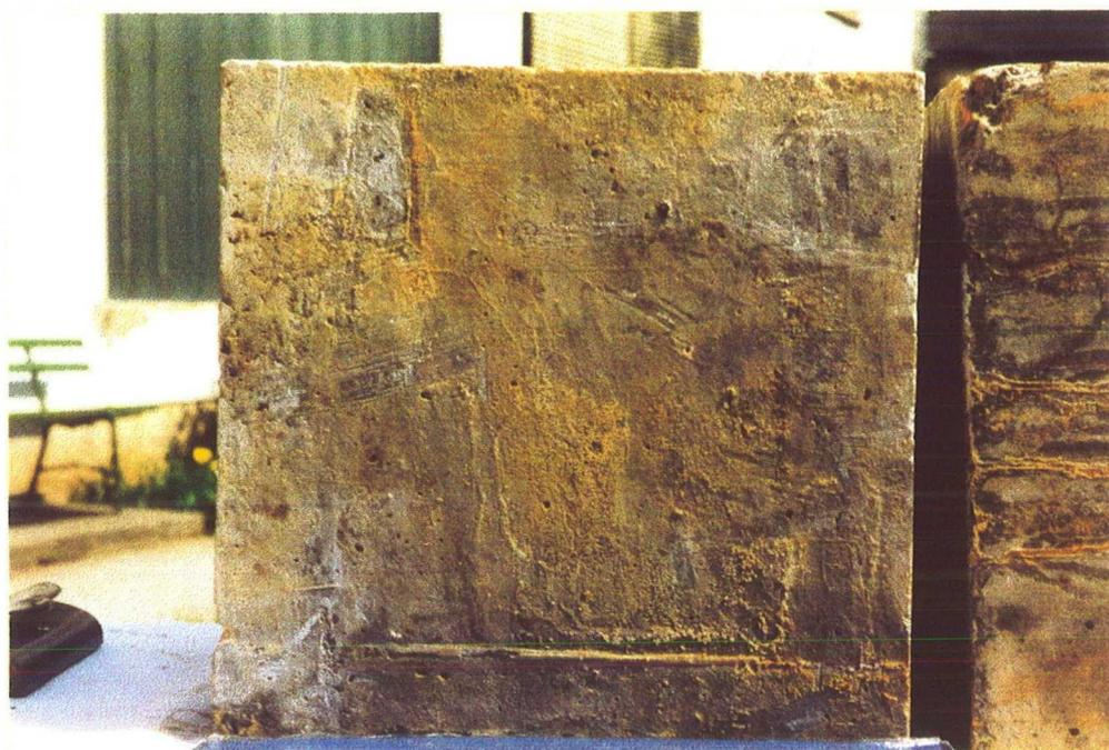
Abb. 15 (Neg.27), V 6, Seitenfläche gegenüber Abb. 14, obere Kante zur Oberseite gehörig 390 d; feine Netzrisse, vorwiegend verheilt
