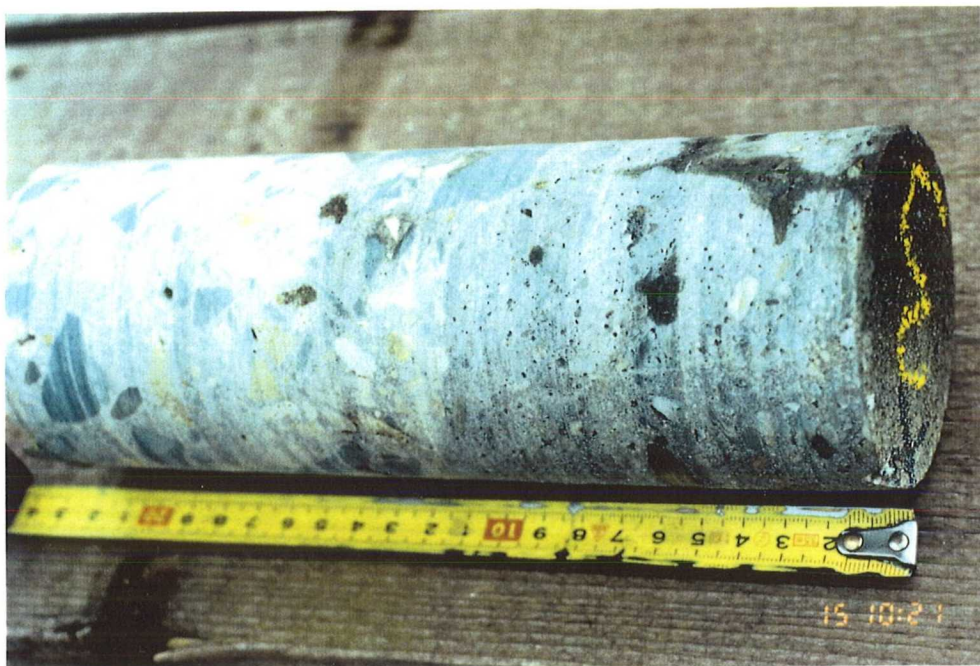
Bild 11: Bohrkern Nr. 3 nach Entnahme
