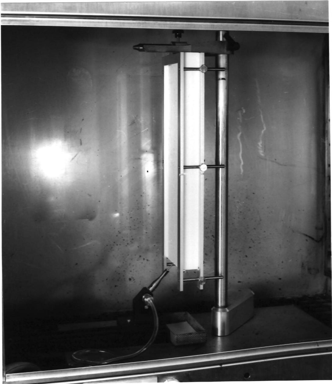
Abb. 2      Schwenkbares Probenhalterstativ im Kleinbrenner-Prüfgerät.
