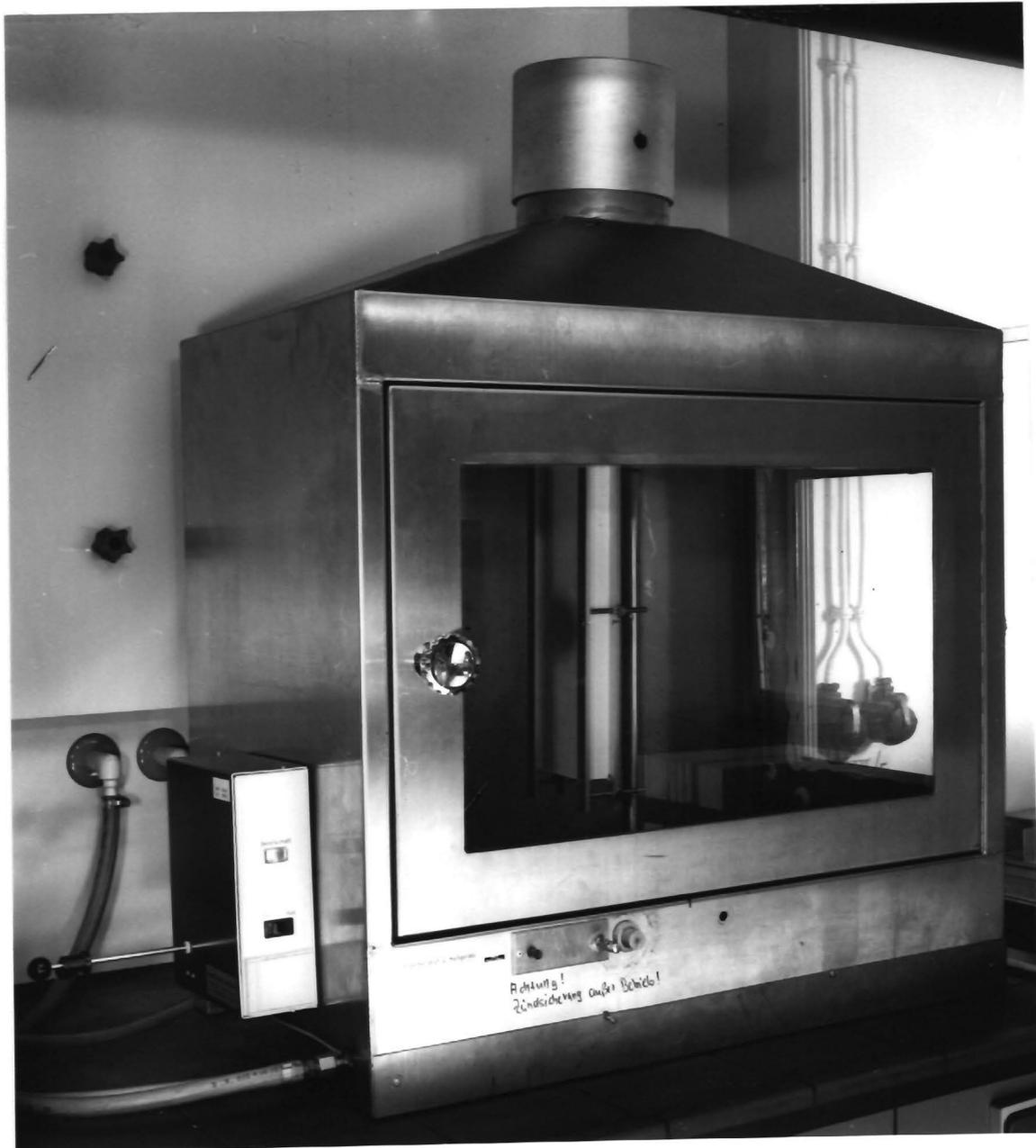
Abb. 1 Kleinbrenner-Prüfgerät mit seitlichem Brennvorschub
