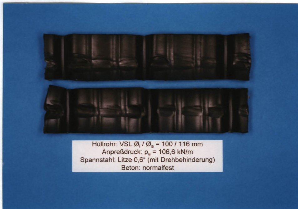
Bild 3.3-2: Reibspur; Hüllrohr: VSL; Anpreßkraft: p_A = 106,7 kN/m; Reibpartner: Litze mit Drehbehinderung
