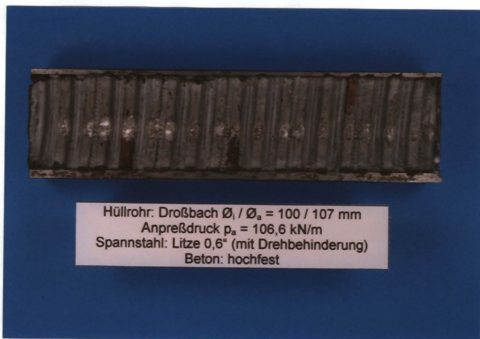
Bild 3.2-15: Plastische Verformung des hochfesten Betons
