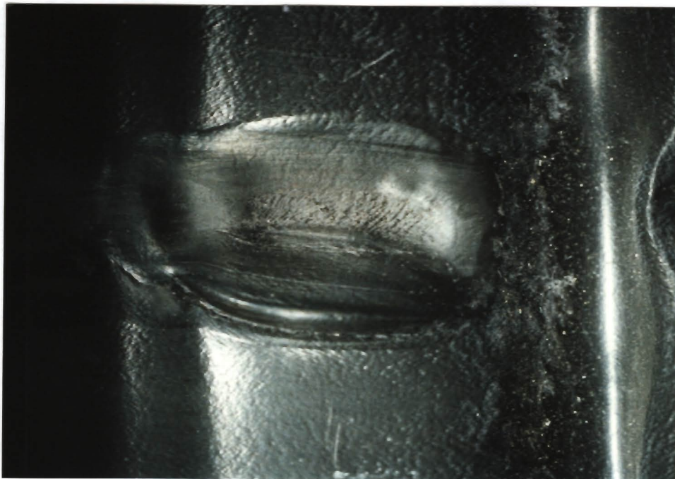
Bild 3.3-5: Detail einer Reibspur auf einer stark beanspruchten Innenwelle; Hüllrohr: VSL; Anfangstemperatur der Probe: T = 20^{\circ}\text{C} ; Reibpartner: Litze mit Drehbehinderung; Anpreßkraft: p_A = 106,7 \text{ kN/m} ; Ziehgeschwindigkeit: v = 0,48 \text{ mm/s}
