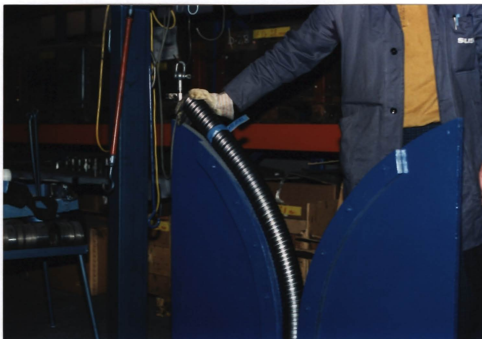
Bild 3.2-7: Prüfung der Verformungswilligkeit
