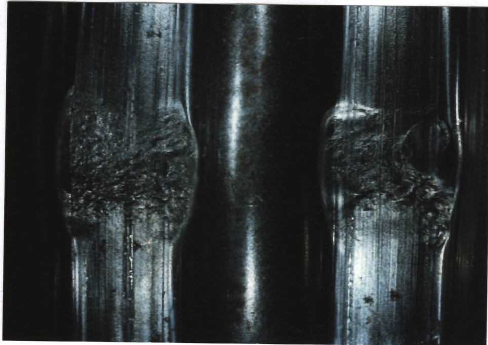
Bild 3.2-12: Hüllrohrrückansicht; Hüllrohr: Witzenmann; Anpreßkraft: p_A = 106,7 \text{ kN/m} ; hochfester Beton
