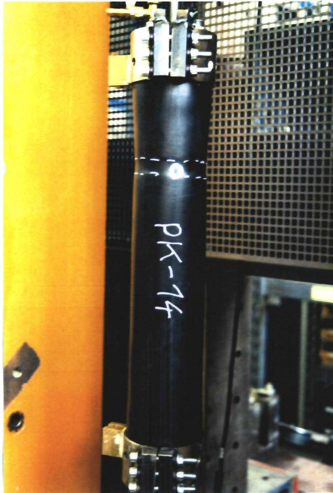
Bild B18: Einschnürung des Probekörpers PK 14 nach dem Dauerstandversuch mit markiertem Riß
