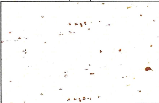
d) Qualitative Korrosionsverteilung (M 1:1)
