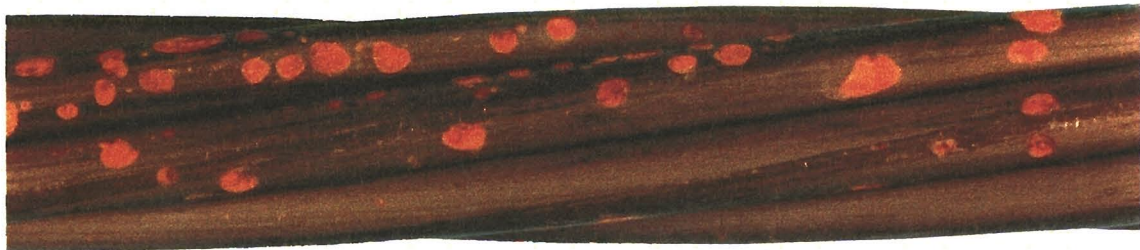
a) Oberfläche von losen Korrosionsprodukten nicht befreit
